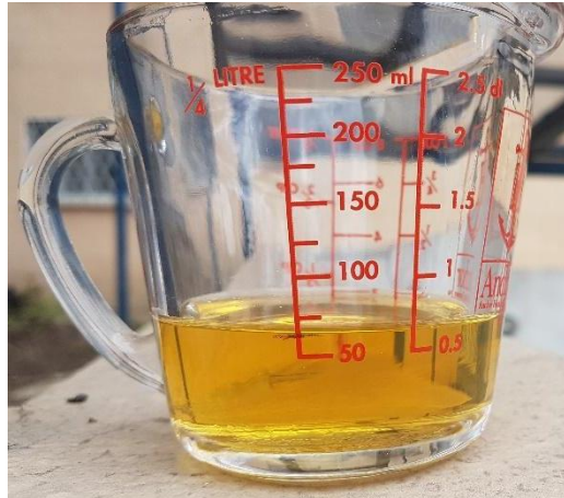
Figura 4: Cantidad de aditivo Bizol para mezclar con 18.93 litros de diésel
