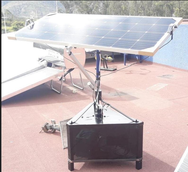
1. Motor no posee anclaje propio, y el peso recae sobre le eje del motor impidiendo la sujeción recta de la viga con el motor
