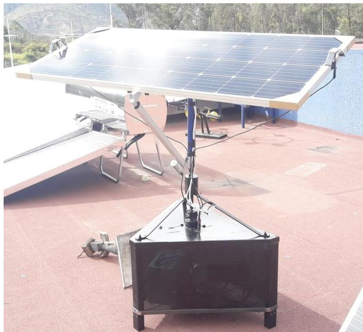
Figura 37. Seguidor solar armado. Autoría Propia
