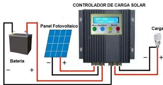
Figura 2. Esquema de componentes de un sistema de captación solar. Tomado de (Rodríguez, 2016)
