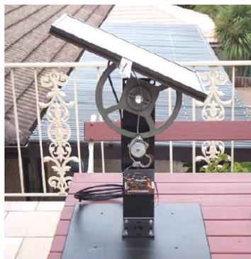
**Figura 4. Prototipo de seguidor solar, tomado de: (Rizk.J & Chayco, 2008).**
