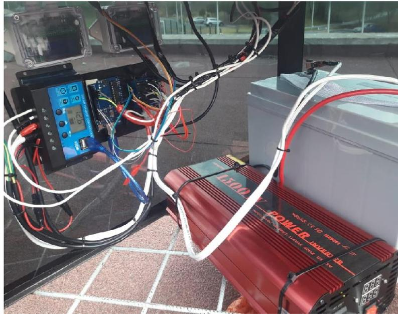
Figura 58. Conexión de componentes al regulador de carga. Autoría propia
