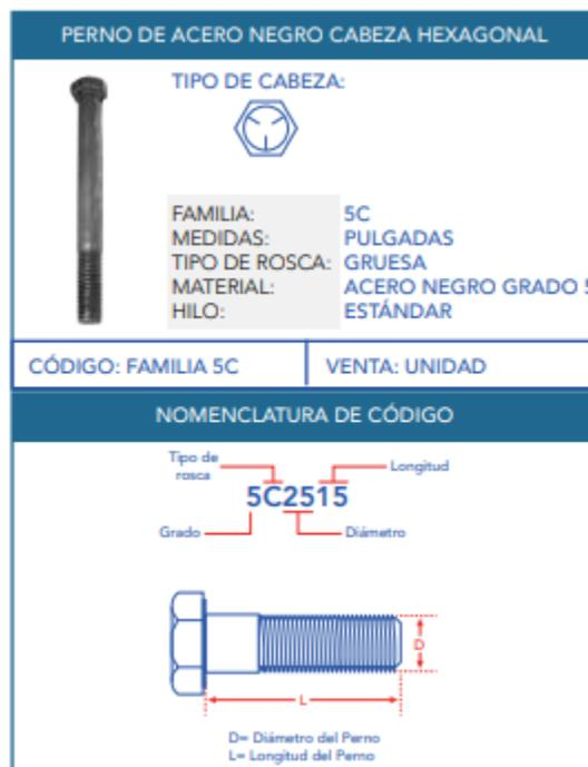
**Figura 47. Especificaciones de perno de acero negro de cabeza hexagonal. (CONSUN, 2018)**
