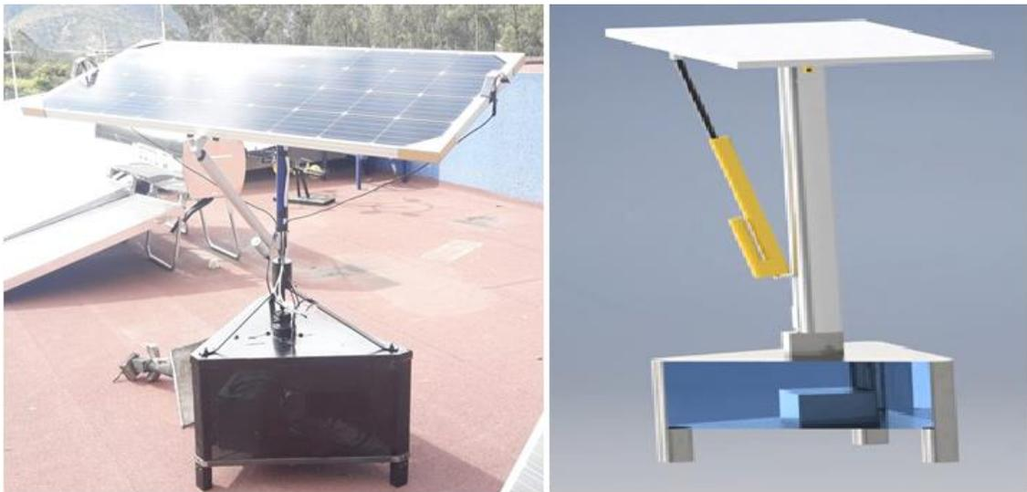
**Figura 59. Prototipo real y virtual del seguidor solar. Autoría Propia**
