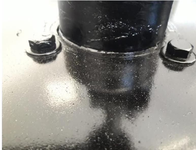
Figura 42. Pernos de sujeción de motor y base. Autoría propia
