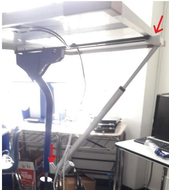
Figura 44. Sujeción de los anclajes del pistón. Autoría propia
