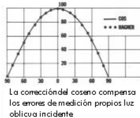
FIGURA92. Curva de corrección del Fotómetro Hagner, modelo EC1-X
