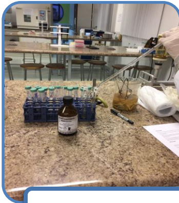
Oxidación con H 2 O 2 y ácido sulfúrico
