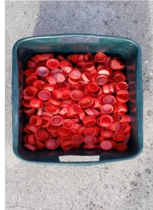
**Figura 14:** Plástico de reciclaje de tapas de polipropileno
