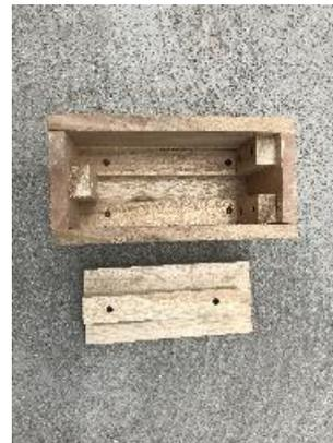
**Figura 16:** Molde del ladrillo para preparación
