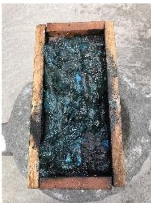
**Figura 21:** Molde lleno del material plástico y compactado el mismo para que adopte la forma de ladrillo
