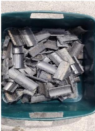
**Figura 13:** Plástico resultante de corte de tubería de polipropileno resultante de tubería utilizada para conducción de agua potable
