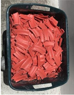
**Figura 11:** Plástico resultante de corte de tubería de polipropileno utilizada para soterramiento de cables
