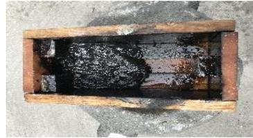
**Figura 18:** Colocación del plástico en estado maleable, en pequeñas cantidades
