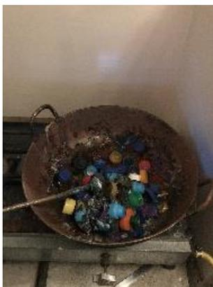
**Figura 15:** Fundición del plástico reciclado
