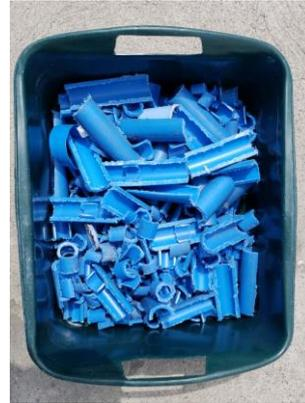
**Figura 12:** Plástico resultante de corte de tubería de polipropileno resultante de tubería utilizada para conducción de agua potable
