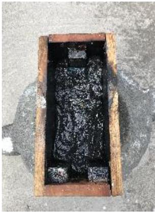
**Figura 19:** Colocación del plástico en estado maleable, en pequeñas cantidades y presión manual para que adopte la forma del molde
