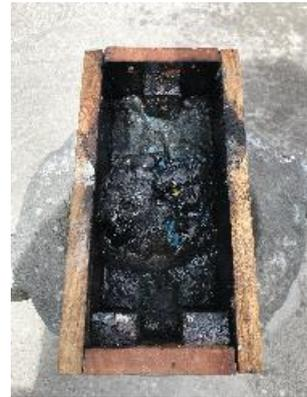
**Figura 20:** Colocación del plástico en estado maleable, en pequeñas cantidades y presión manual para que adopte la forma del molde
