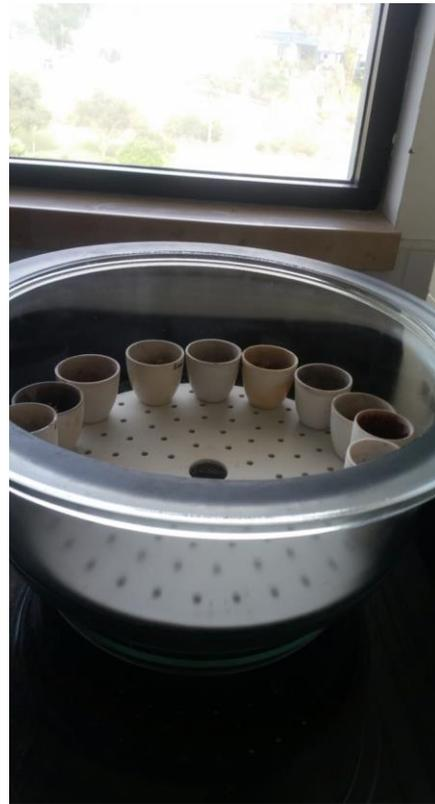
Una vez evaporada la humedad, se colocan las muestras secas a 650° durante 4 horas, volatizando de esta forma toda la materia orgánica compuesta de carbono.
