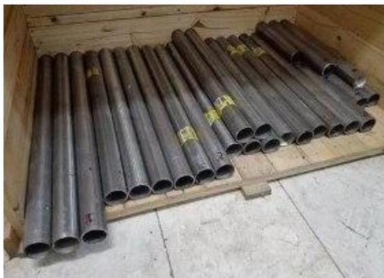
*Figura 6.* Tubería Aluminada (Yhasmin Reyes, AliciaDurán, & YolandaCastro 2015).
