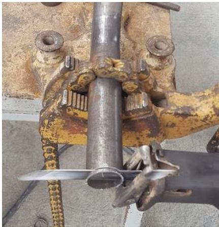
Figura 27. Corte de tubería según su longitud.
