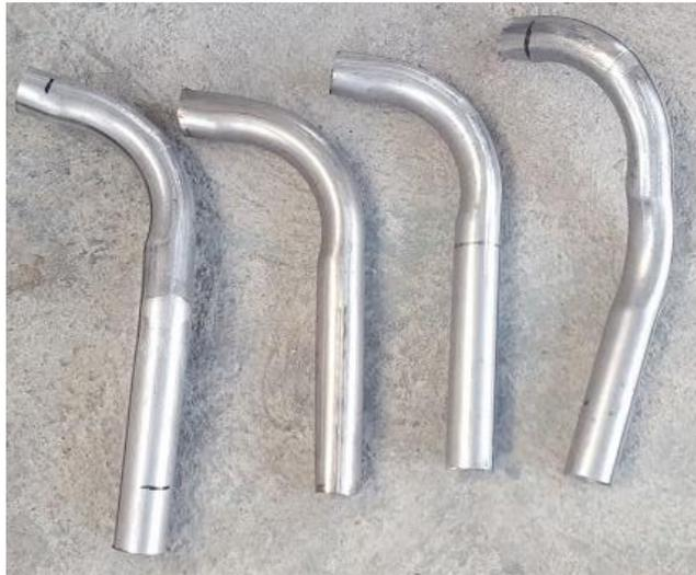
*Figura 29.* Dobles de tubos según el diseño.
