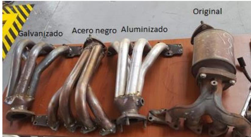
*Figura 36.* Múltiple de escape original y 3 header's con materiales no tradicionales.
