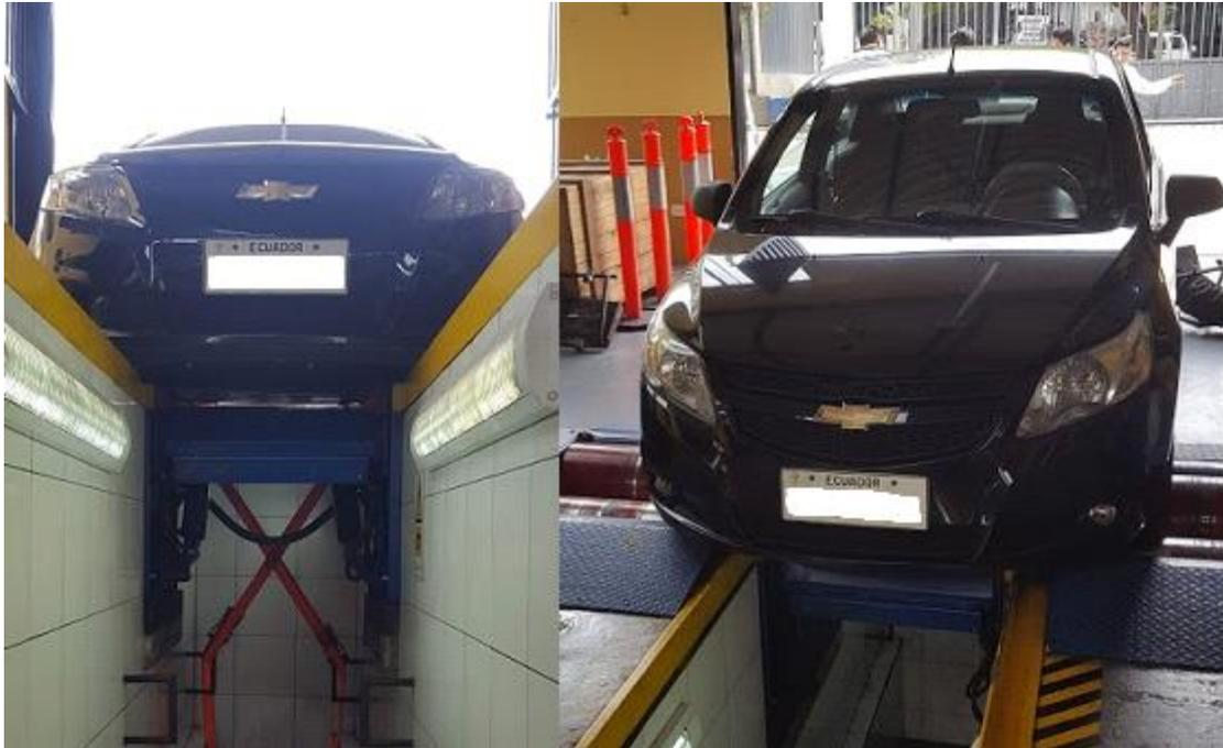
Figura 32. Fijación del vehículo en el banco dinamométrico.
