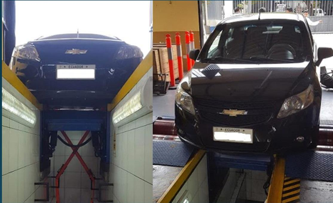
Las pruebas dinamométricas se llevaron según la norma INEN 960, basada en la ISO 1585 y la ISO 3173, obteniendo las curvas características del vehículo de torque y potencia mediante 3 ensayos, con el sistema de escape original, escape de acero negro, escape galvanizado y escape aluminizado.
