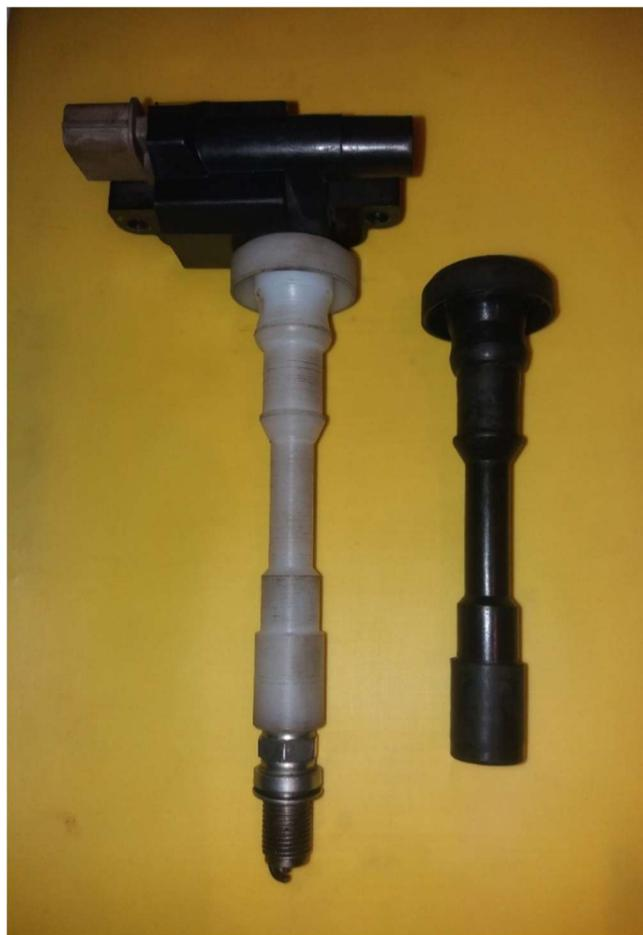
Figura 41. Prototipo de SPB Mecanizado en Nylon Vs. Original
