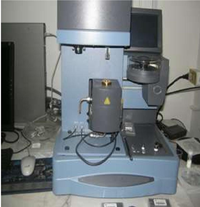
*Figura 15.* Analizador Termogravimétrico TGA
