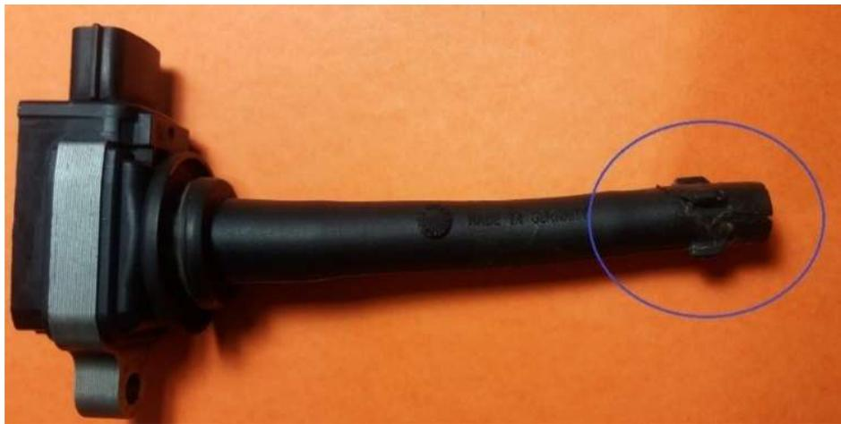
*Figura 3.* Bobina COP con grietas en SPB
