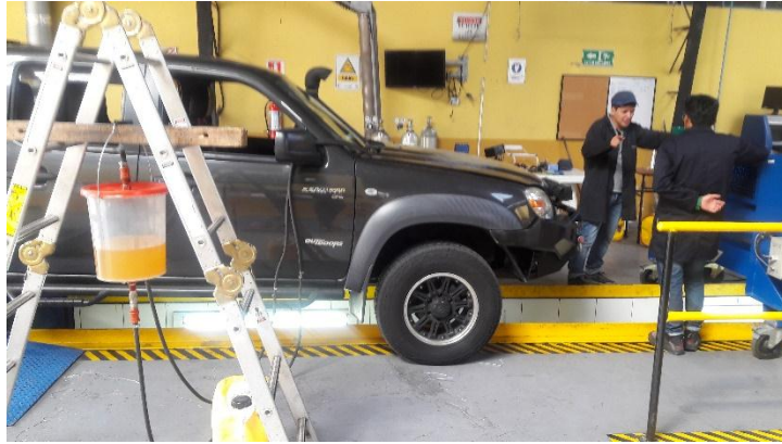
Figura 16. Ubicación del depósito para pruebas con el dinamómetro
