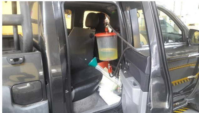
Figura 8. Sujeción e instalación del depósito
