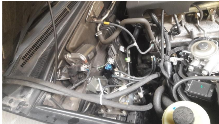
Figura 17. Instalación de mangueras de combustible
