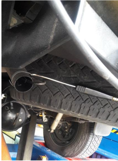
Figura 7. Sujeción de la sonda del analizador de gases
