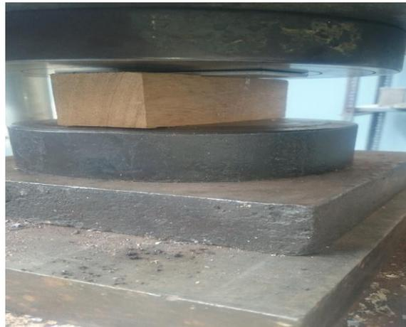
Figura 5. *Compresión perpendicular a la fibra de la madera*
