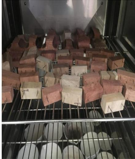
*Figura 9.* Secado en horno para ensayos de Hinchamiento Volumétrico
