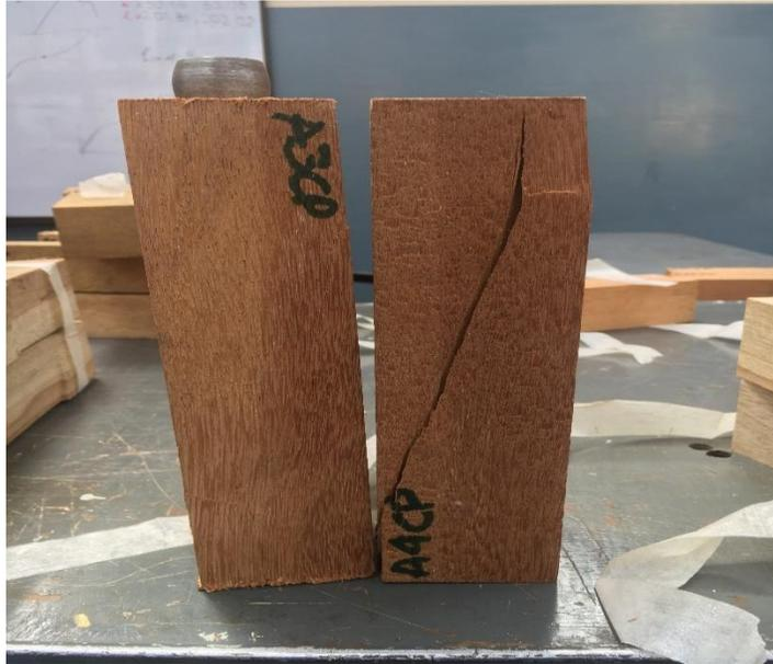
Figura 4. Compresión paralela a la fibra de la madera.
