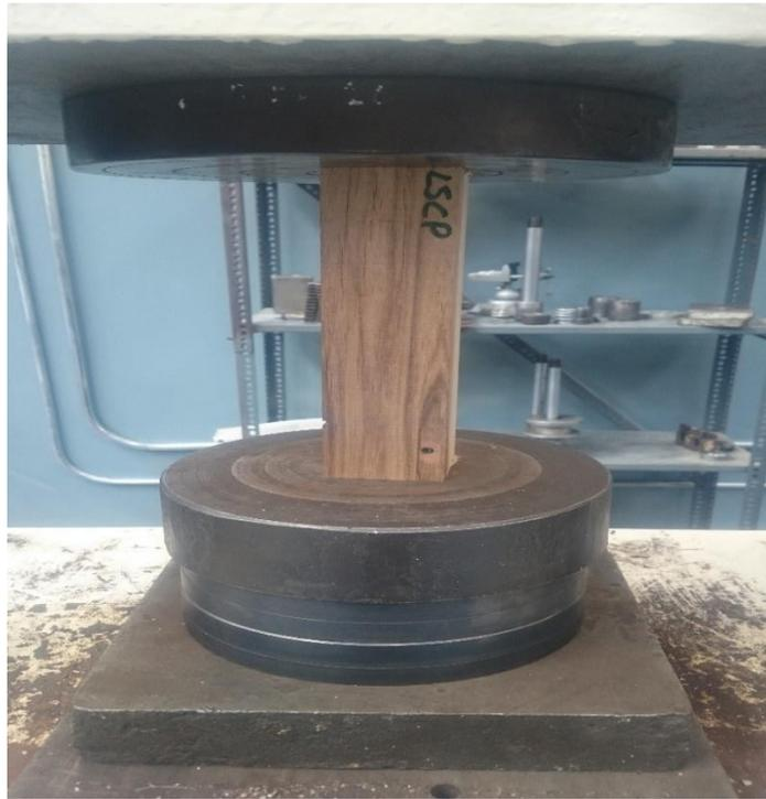
*Figura 3.* Procedimiento de compresión paralela a la fibra de la madera
