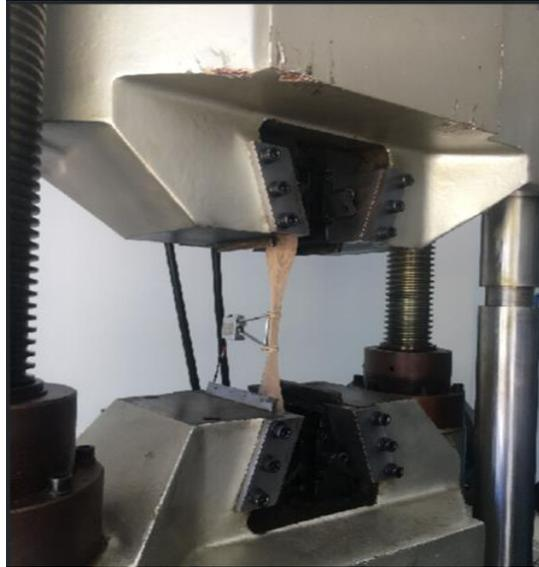
*Figura 6.* Tracción paralela a la fibra de la madera
