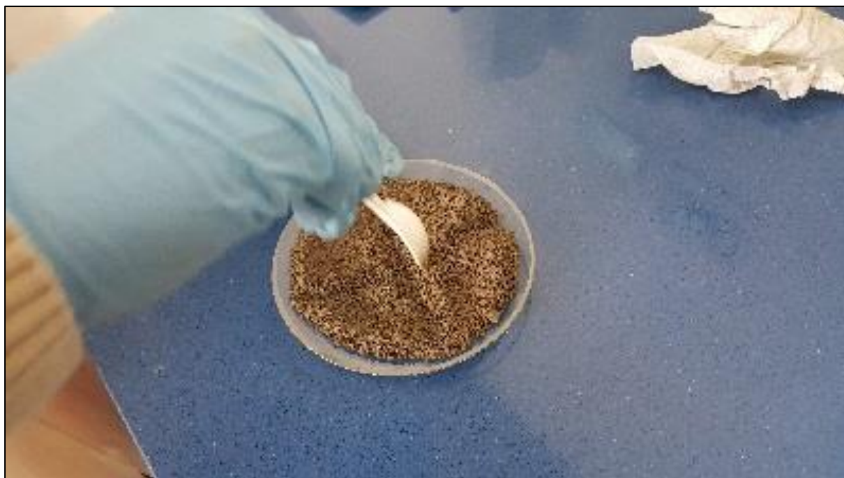
Figura 24. Cuarteo para la toma de muestra para la lixiviación
