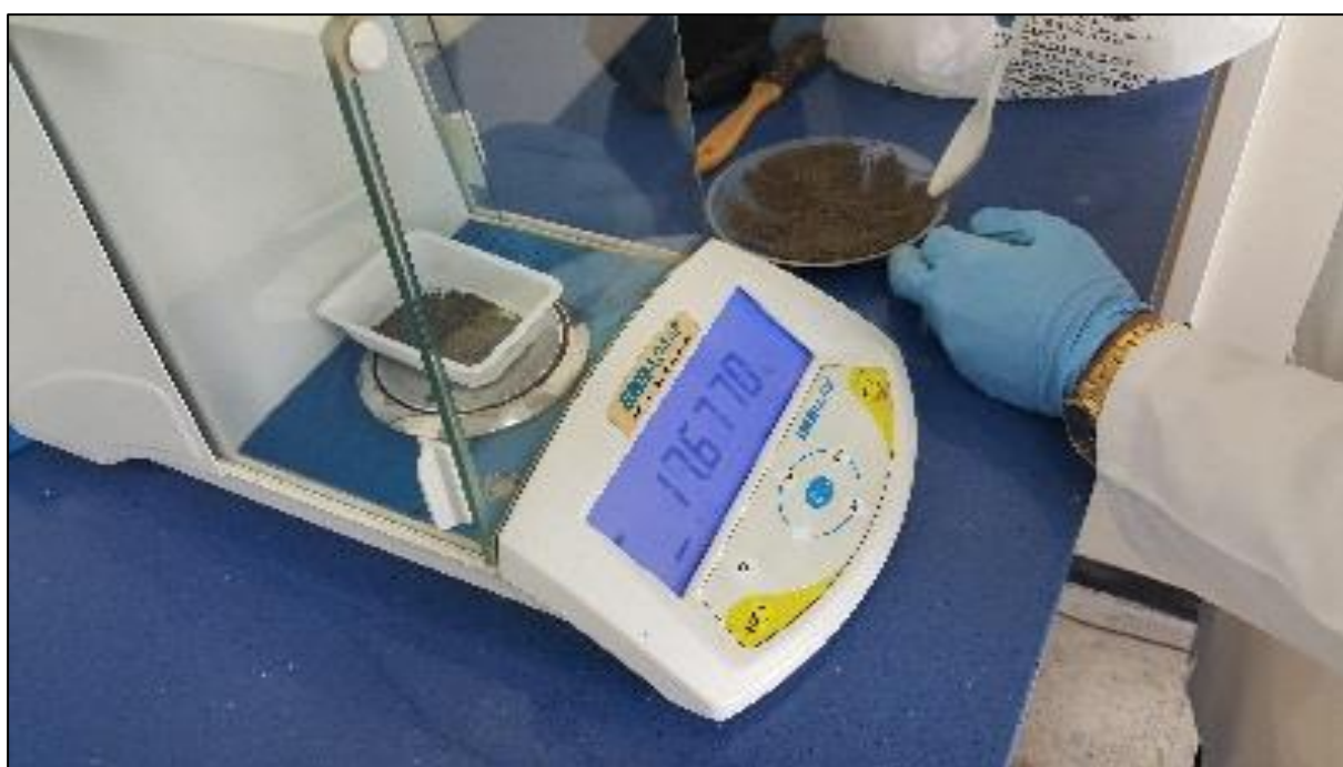
Figura 25. Pesaje de las muestras a lixiviar (aprox. 20 g) en el Laboratorio de Análisis Instrumental de la EPN
