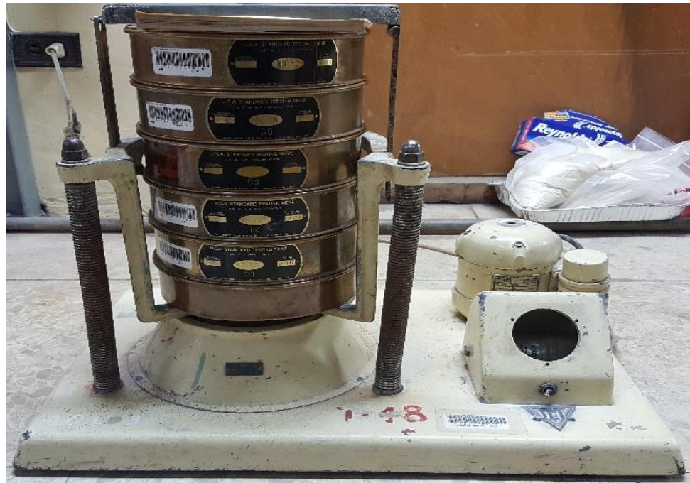
Figura 23. Juego de mallas y agitador del Laboratorio de Operaciones Unitarias de la EPN para la caracterización de la granulometría de las muestras
