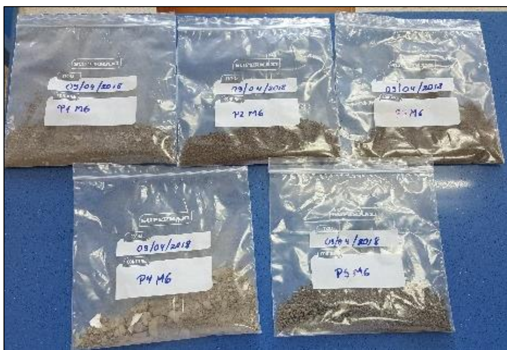
Figura 31. Sedimentos secos obtenido de la filtración para enviar a un laboratorio acreditado y analizar los metales pesados
