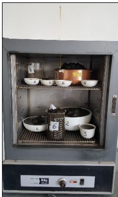
Figura 20. Secado de las muestras a una temperatura menor a 80°C en una estufa del Laboratorio de Análisis Instrumental de la EPN
