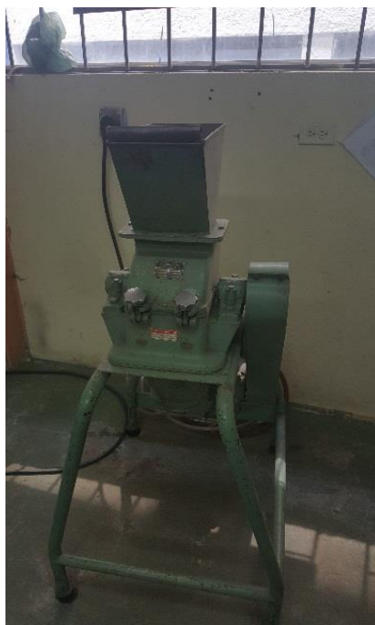
Figura 22. Molino de martillos del Laboratorio de Operaciones Unitarias de la EPN para la molienda de las muestras
