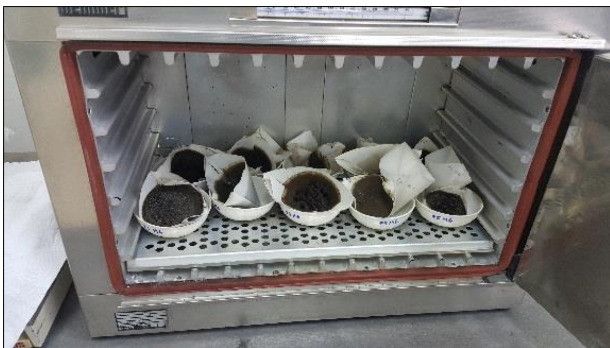
Figura 29. Secado de las muestras agitadas a 30 RPM durante 96 h a una temperatura menor a 80°C en una estufa del Laboratorio de Análisis Instrumental de la EPN
