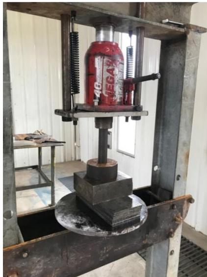
**Figura 27.** Prensa hidráulica manual
