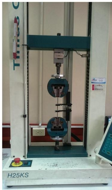
**Figura 28.** Máquina Universal de ensayos marca Tinius Olsen modelo H25KS
