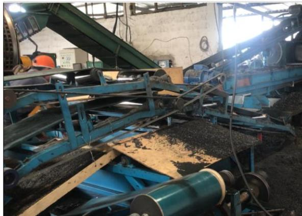
**Figura 11.** Primer tamizaje de caucho molido
