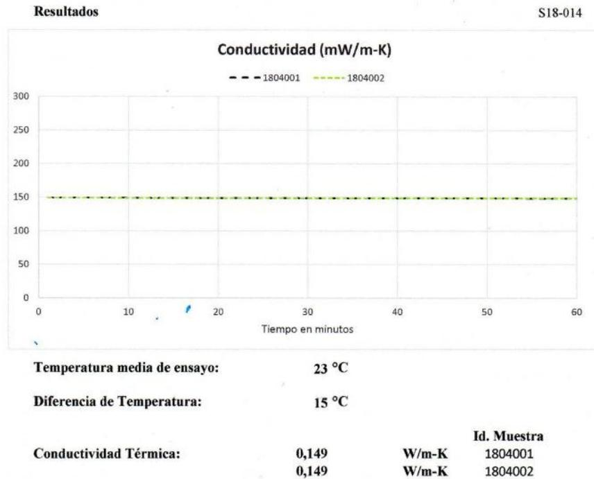
**Figura 76.** Gráfico de ensayo conductividad térmica.
