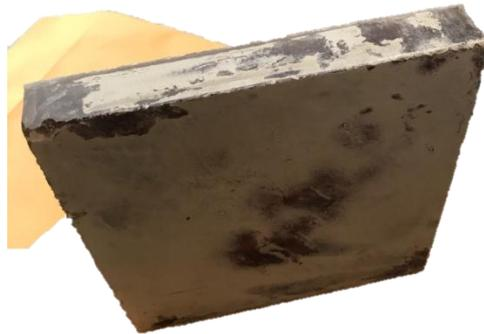
**Figura 41.** Probetas para ensayo de conductividad térmica
