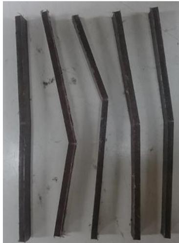
**Figura 71.** Probetas de material compuesto "NFSE1.5" después de los ensayos de flexión.
