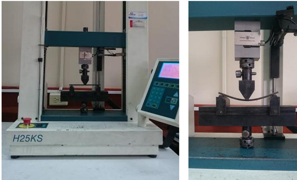
**Figura 43.** Ensayo de flexión realizado a una probeta de material compuesto, siguiendo los parámetros de la norma ASTM D7264/D7264M-15.
