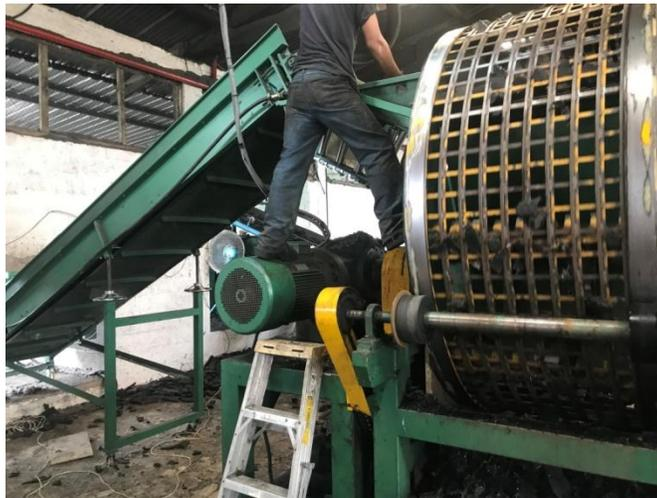
**Figura 10.** Máquina para picado de las tiras de caucho
