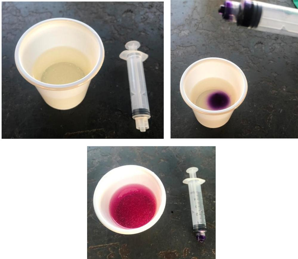
**Figura 34.** Mezcla obtenida al mezclar resina, estireno y Octoato de cobalto
