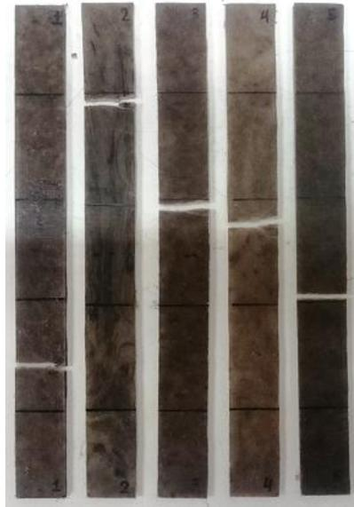
**Figura 65.** Probetas de material compuesto "NTSE1.5" después de los ensayos de tracción.
