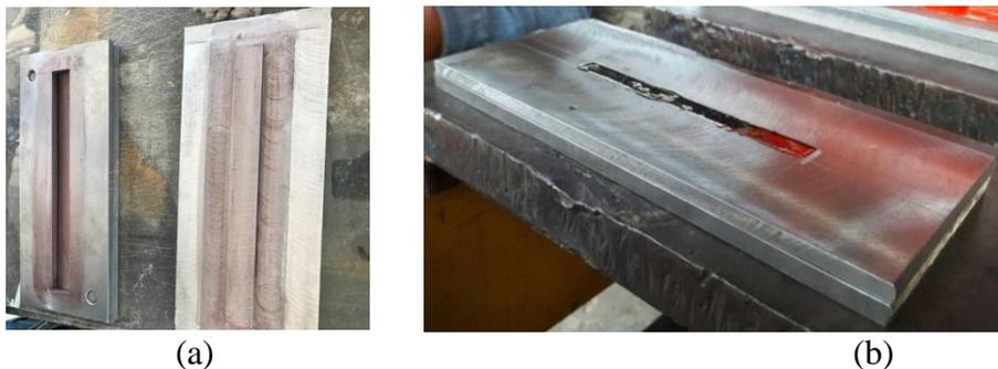
**Figura 22.** Moldes para: (a) ensayo a tracción; (b) ensayo a flexión
