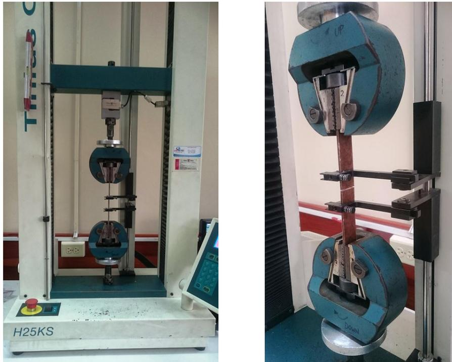
**Figura 42.** Ensayo de tracción realizado a una probeta de material compuesto, siguiendo los parámetros de la norma ASTM D3039/D3039M-17.
