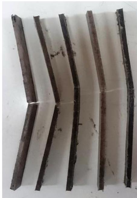
**Figura 70.** Probetas de material compuesto "NFC1.5" después de los ensayos de flexión
