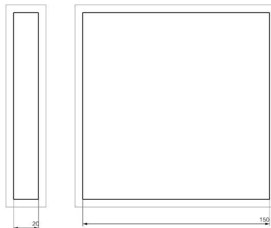
**Figura 25.** Probeta para ensayo de conductividad térmica con sus respectivas dimensiones, según la norma ISO 8302
