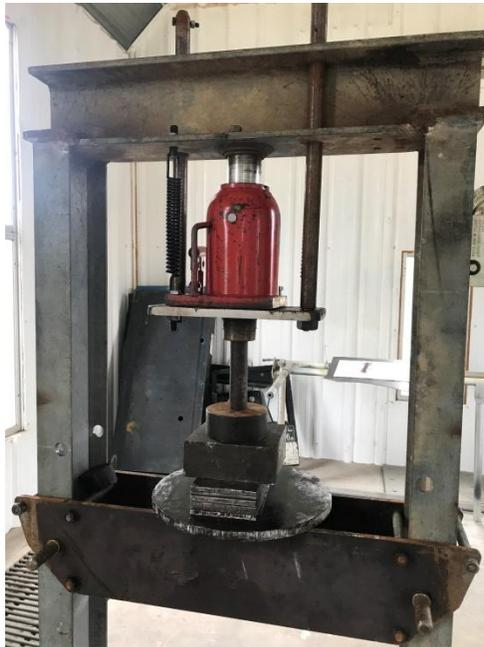
**Figura 38.** Ubicación de molde en prensa hidráulica
