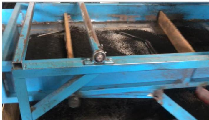
**Figura 13.** Segundo tamizaje del polvo de caucho
