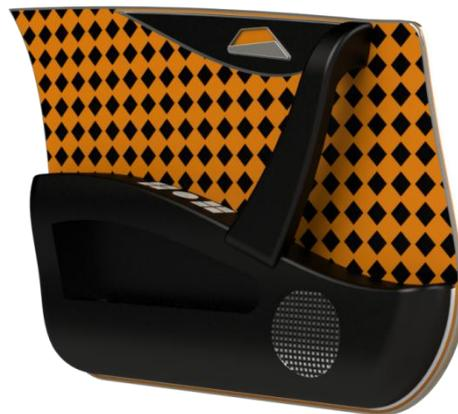
**Figura 45.** Modelado de panel de puerta interior
