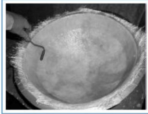
**Figura 3.** Método de estratificación manual aplicado en la fabricación de un domo.
