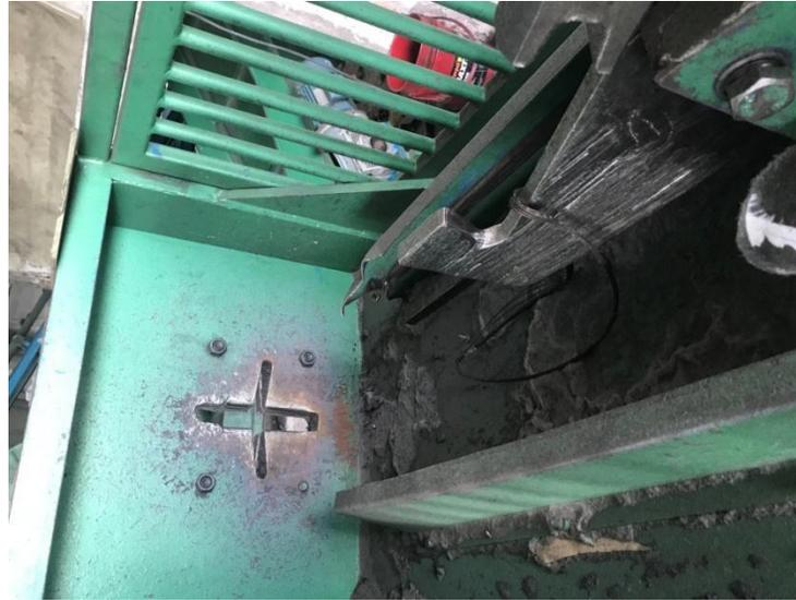
**Figura 9.** Máquina para corte lateral en la Planta Rubberaction
