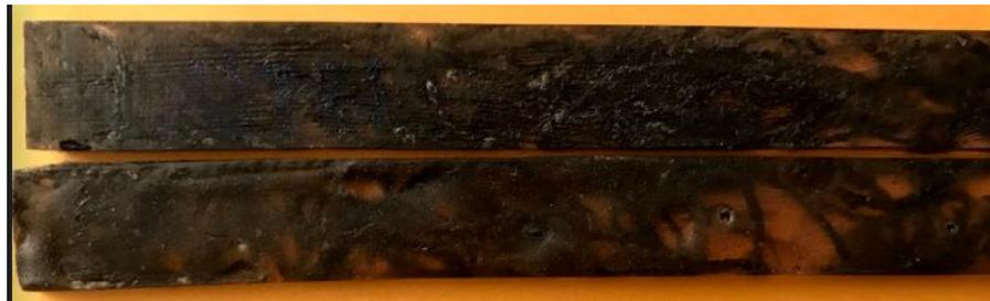
**Figura 39.** Probetas para ensayo a tracción
