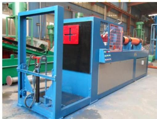
**Figura 8.** Máquina para corte lateral de neumáticos
