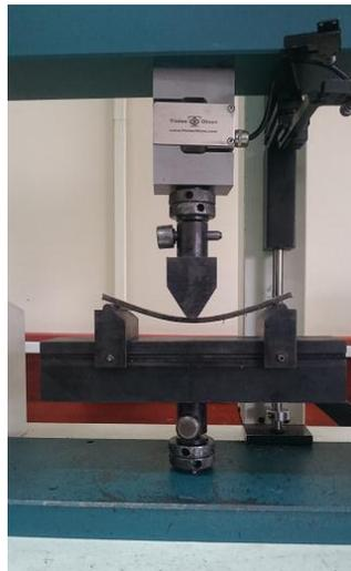
**Figura 30.** Equipo de flexión a tres puntos
