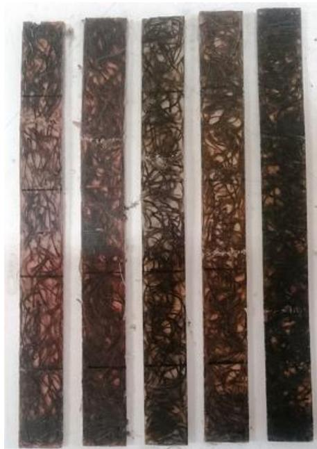
**Figura 66.** Probetas de material compuesto "NH1g" después de los ensayos de tracción.
