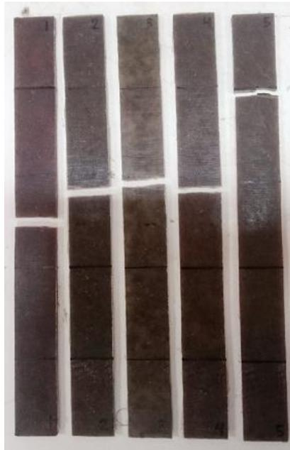
**Figura 64.** Probetas de material compuesto "NTC1.5" después de los ensayos de tracción
