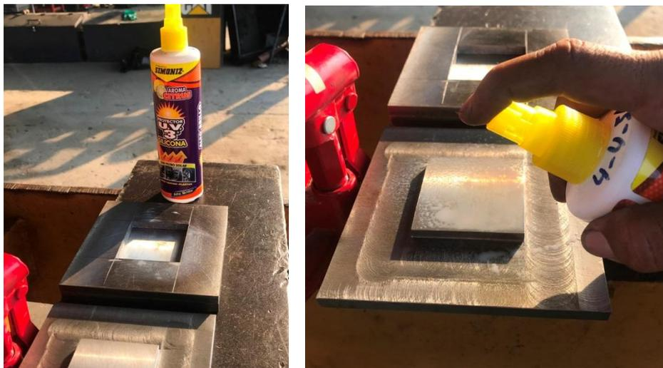
**Figura 33.** Aplicación de cera desmoldante
