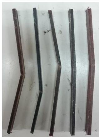
**Figura 72.** Probetas de material compuesto "NFC1g" después de los ensayos de flexión
