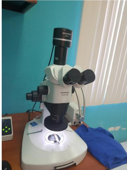
*Figura 30.* Equipo estereoscópico digital.
