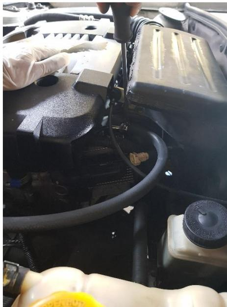
*Figura 20.* Conexión del canister a la riel de inyectores.
