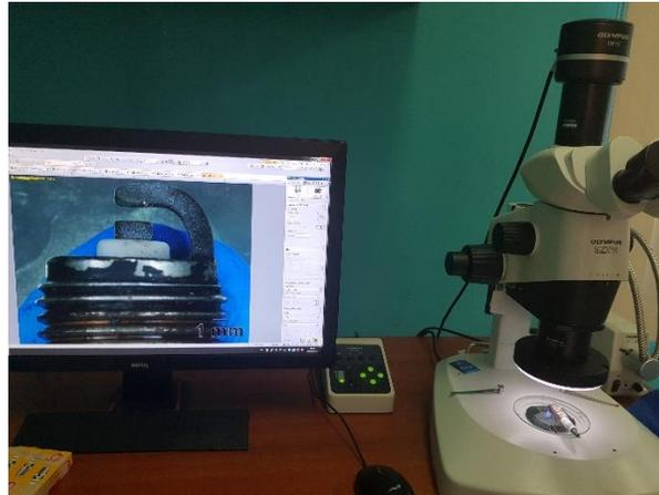
*Figura 32.* Análisis de información de bujías de encendido.
