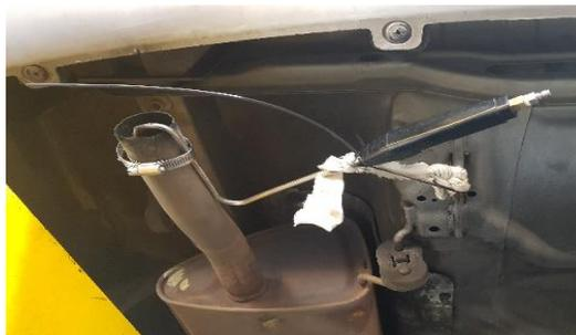
*Figura 22.* Colocación de la sonda de gases en el sistema de escape del vehículo.
