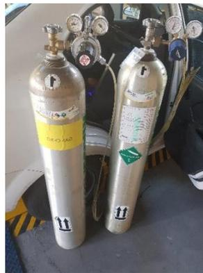
*Figura 23. Tanques de calibración.*
