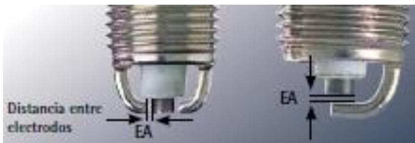
Figura 9. Distancia entre electrodos
