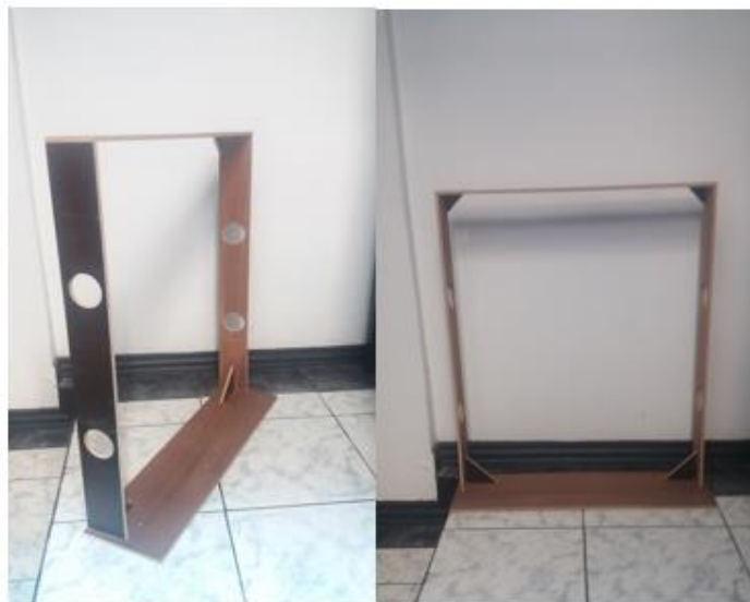
Foto 4. Estructura de madera diseñada para el reactor acuapónico.
