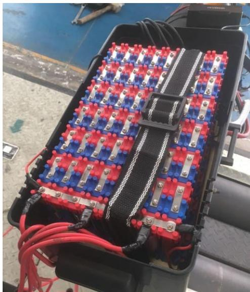
*Figure 25.* Caja de plástico con pack de baterías.
