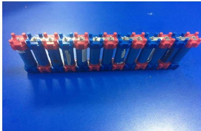
*Figure 16.* Paquete de 13 celdas conectadas en serie.
