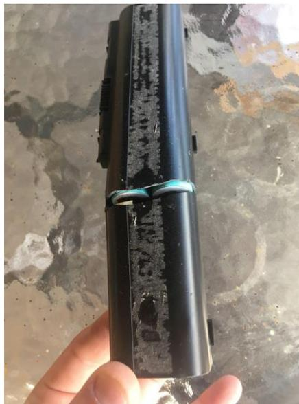
*Figure 13.* Batería reciclada de laptop abierta para la extracción de las celdas.
