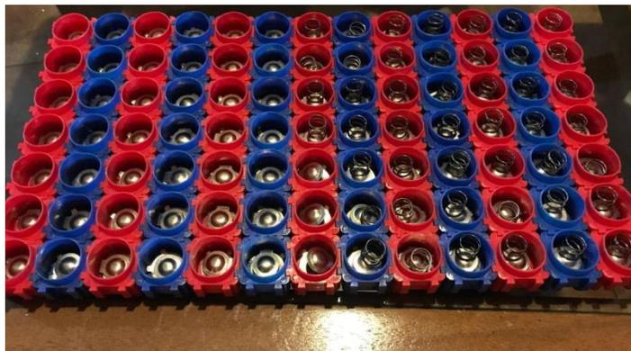
*Figure 17.* Instalación de resortes en la plancha inferior de zócalos.
