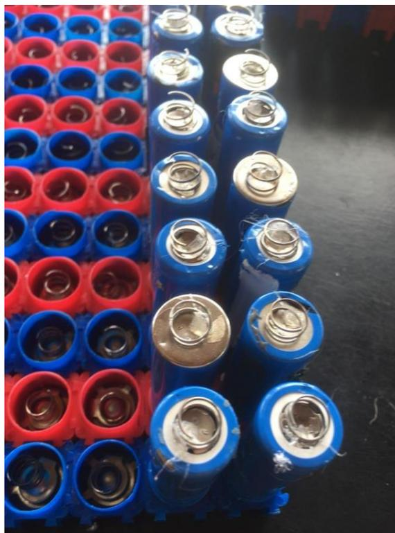
*Figure 19.* Instalación de resortes sobre terminales de las celdas.
