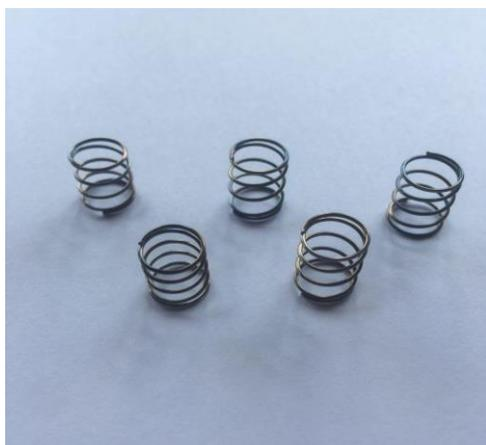
*Figure 10.* Resortes para mejorar conectividad entre celdas y terminales.
