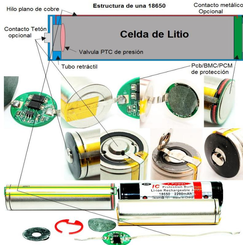
*Figure 3.* Composición interna y externa de celda de litio 18650. Tomado de: (Baterías de litio, 2014)
