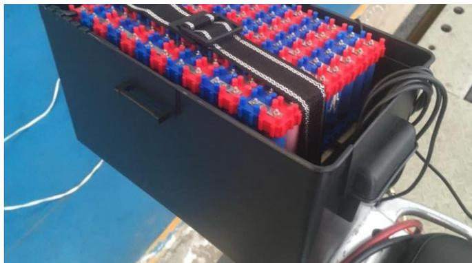
*Figure 27.* Caja con batería y sus componentes.
