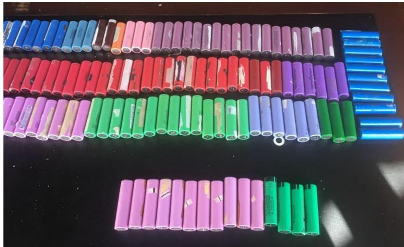
*Figure 8.* Celdas de ion-litio reutilizadas 18650.
