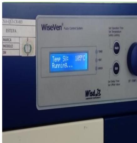
*Figura 15.* Horno de secado temperatura  $103^{\circ}\text{C} \pm 2^{\circ}\text{C}$
