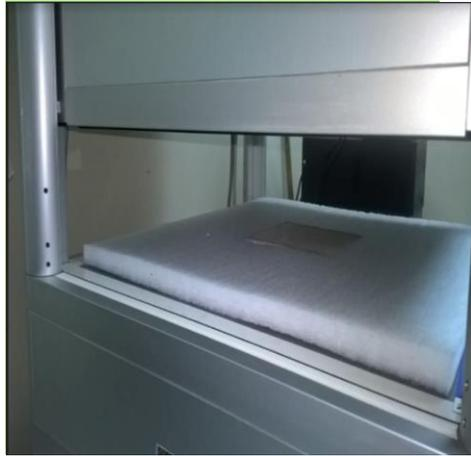
*Figura 11.* Probeta de hormigón Holcim en Máquina  $\lambda$ -Meter EP500e, Versión C.
