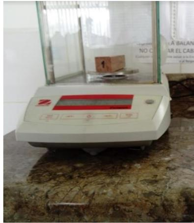
*Figura 16.* Peso de la madera dura roble en estado anhidro (Ps)
