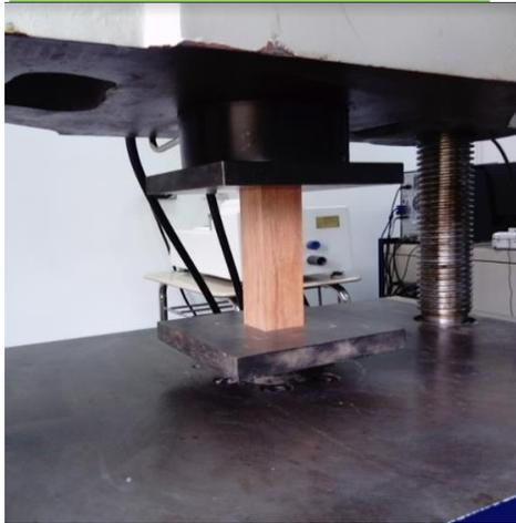
Figura 19. Ensayo de Compresión Paralela
