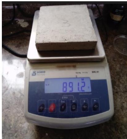
*Figura 17.* Peso del hormigón en estado anhidro (Ps)
