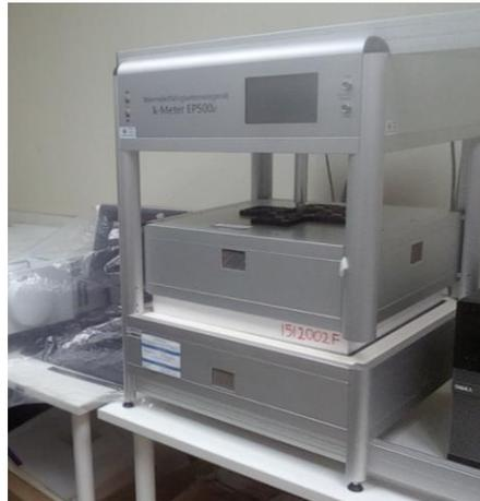
Figura 7. Máquina  $\lambda$ -Meter EP500e, Versión C. Tomado en la ESPOL
