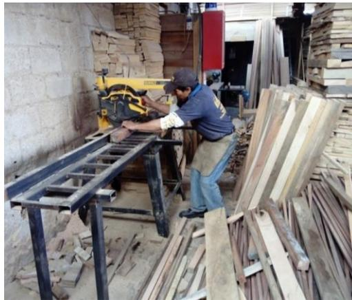
*Figura 3.* Preparación de probetas madera dura roble. Tomado de (*Tecnimadera, 2018*)
