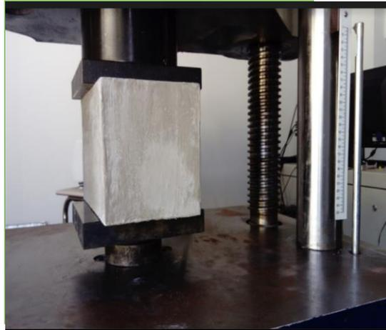
*Figura 25. Ensayo de Compresión Perpendicular*
