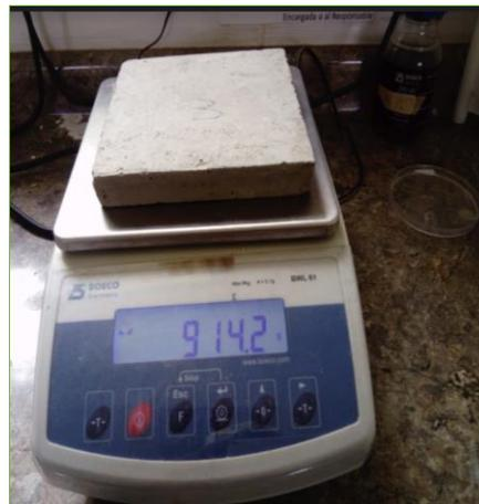
*Figura 13.* Peso del hormigón en su estado húmedo inicial (Ph)
