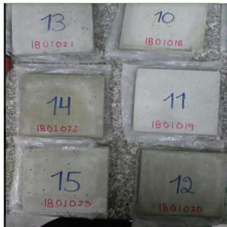
*Figura 10.* Codificación de probetas del hormigón cemento Holcim
