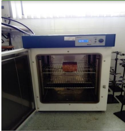
*Figura 14.* Horno de secado madera dura roble
