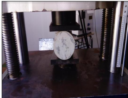
Figura 29. Ensayo de Tracción Laboratorio UISEK
