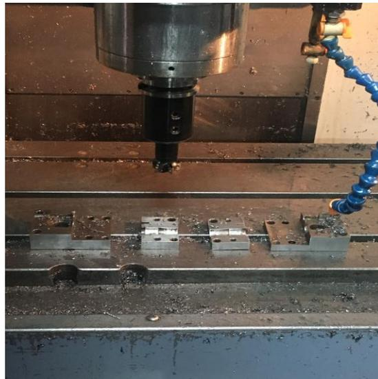
*Figura 67.* Resultado del mecanizado total de los moldes (Autor, 2017).
