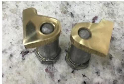
*Figura 18.* Inclusiones para manipulación del espécimen (Autor, 2017).
