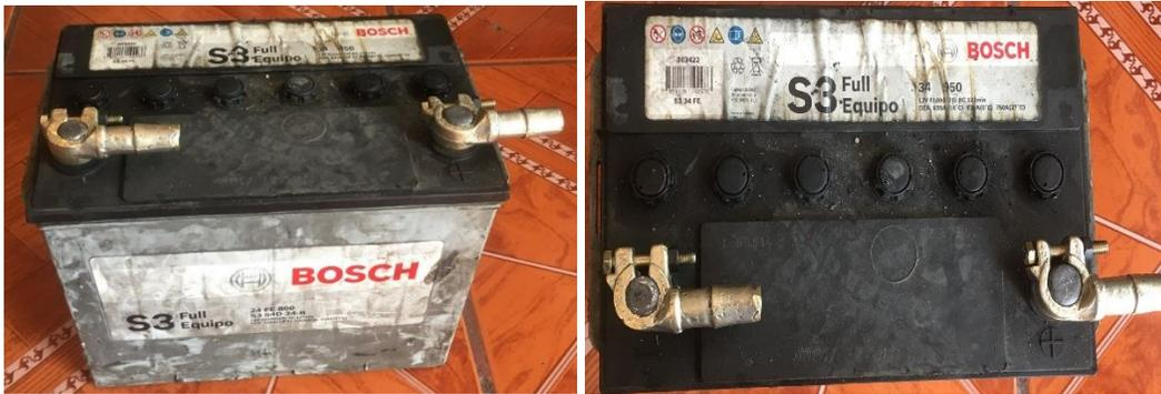
Figura 75. Bornes positivo y negativo acoplados a batería convencional (Autor, 2017).
