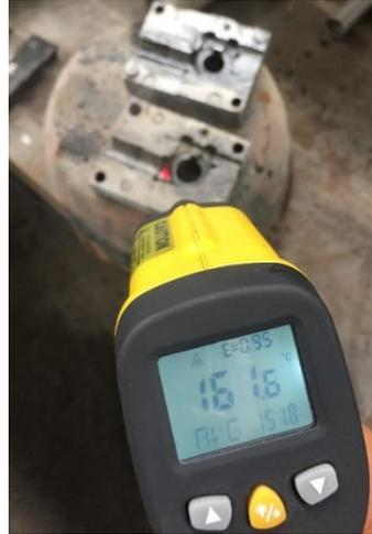
*Figura 48.* Termómetro infrarrojo apuntando a moldes (Autor, 2017).
