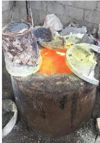
*Figura 46.* Horno con crisol de hierro fundido recubierto térmicamente (Autor, 2017).
