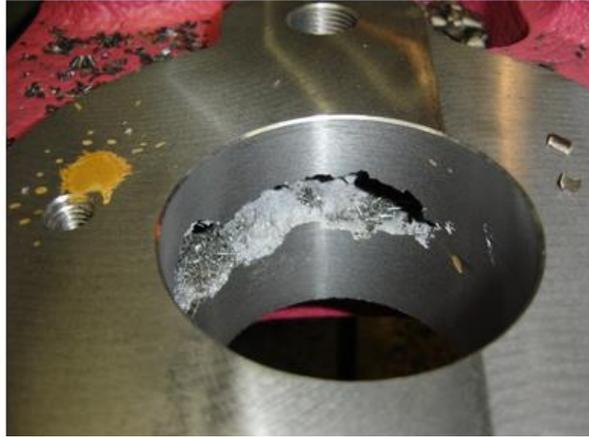
*Figura 9.* Pieza con rechupe en el centro del cuerpo (Fundiciones Fumbarri Durango, S.A, 2013)
