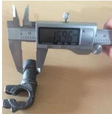
*Figura 30.* Medición de borne original (Autor, 2017).
