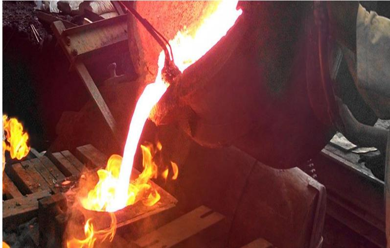
*Figura 6.* Colado de material en molde permanente (FUNPIMET, 2016).
