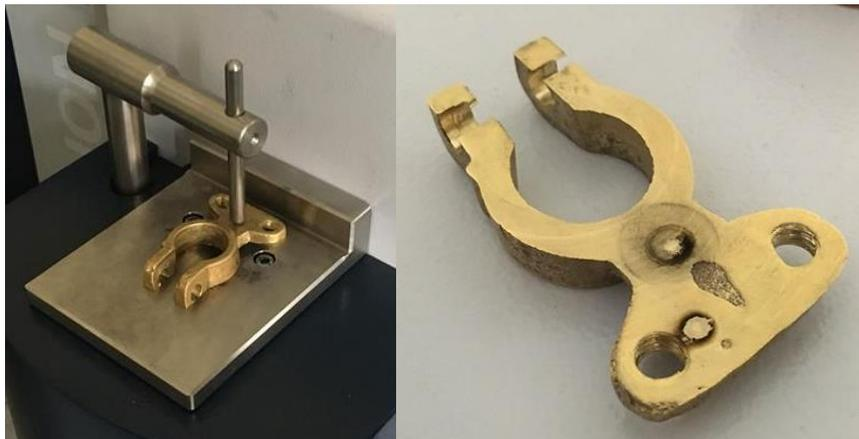
*Figura 27.* Espectrometría en borne de fabricación nacional (Autor, 2017).
