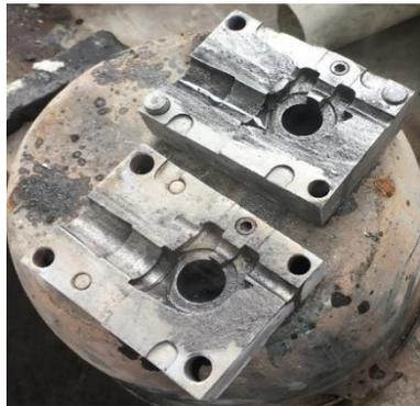
*Figura 49.* Moldes con capa para desmoldeo (Autor, 2017).
