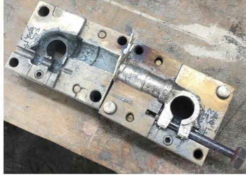
*Figura 52.* Obtención de borne fundido (Autor, 2017).
