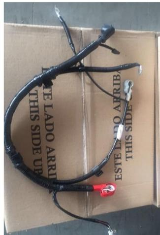
*Figura 1.* Bornes de batería con incorporación de arnés importados (Autor, 2017).
