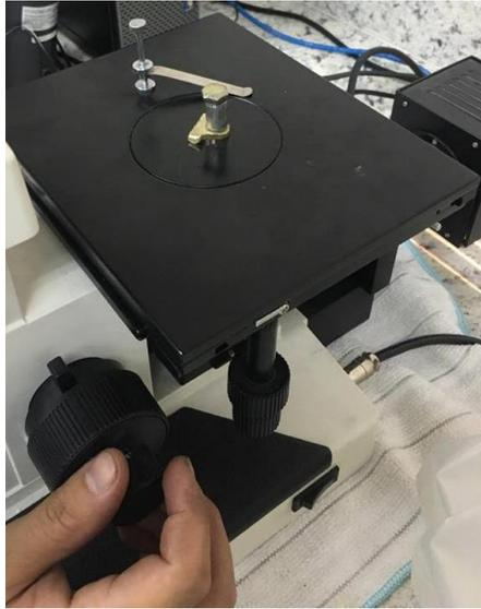
*Figura 25.* Ubicación de muestra en microscopio (Autor, 2017).
