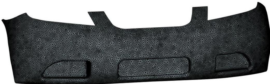
Figura 58. Mallado del modelo CAD del guardachoque del vehículo Chevrolet Aveo.
