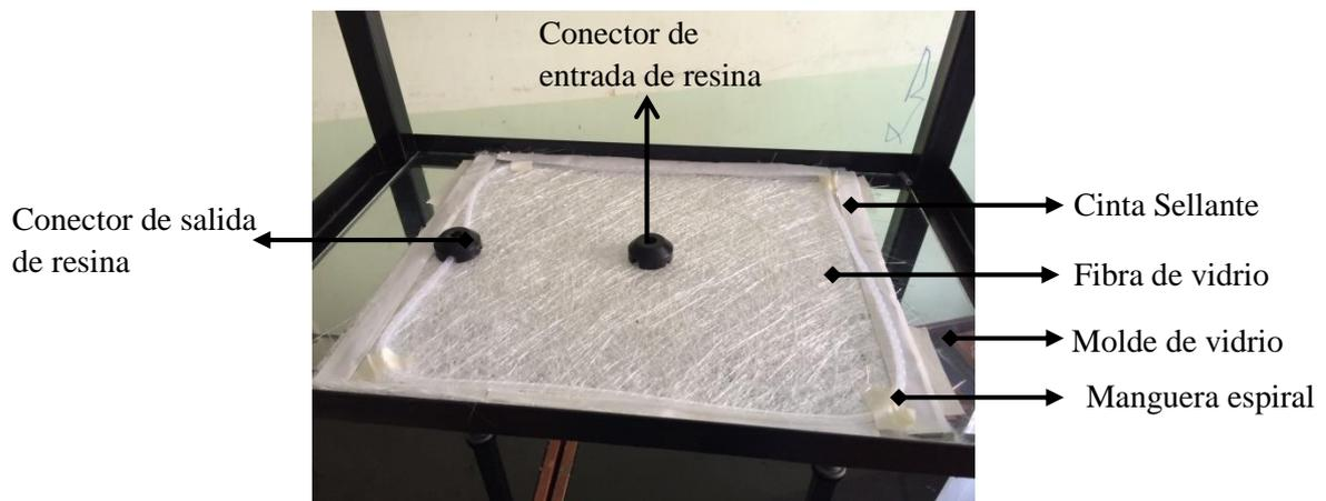
Figura 49. Disposición de la cinta sellante, conectores de silicón, manguera espiral y fibra de vidrio sobre el molde
