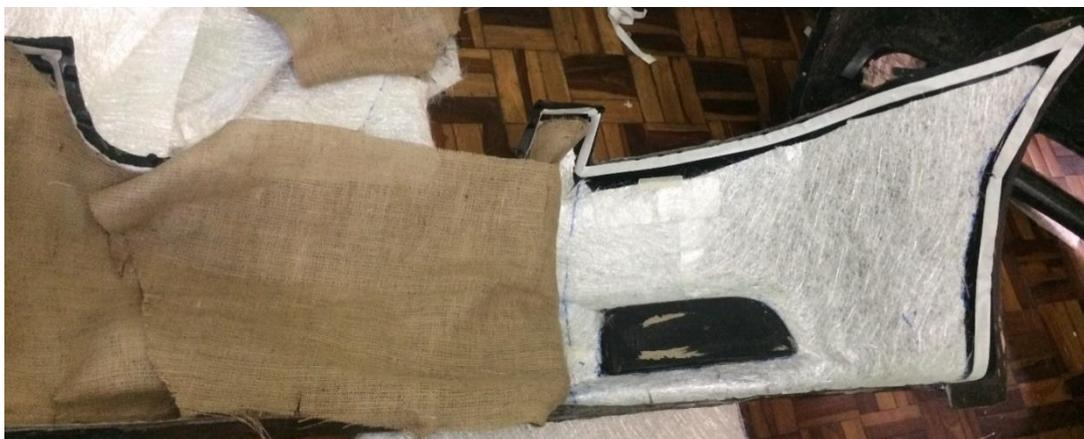
*Figura 67.* Disposición de las fibras de vidrio y cabuya sobre el molde.
