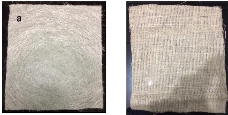
Figura 47. Tipos de fibras utilizadas: a) Fibra de vidrio Choped Strand Mat y b) Fibra de cabuya tejida
