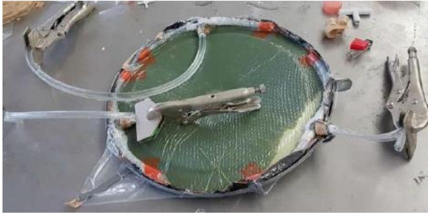
Figura 27. Proceso de infusión de resina terminado para la fabricación de una tapa de filtro de aire (Chávez y Ledesma, 2016).
