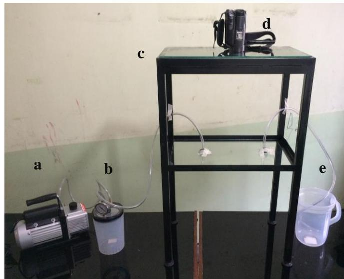
Figura 50. Montaje del equipo para la caracterización de la permeabilidad.
