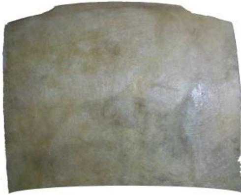
Figura 17. Prototipo de Capot fabricado mediante *Hand-Lay up* (Pachacama, 2015).
