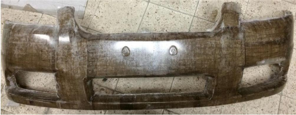
Figura 90. Vista frontal del prototipo de guardachoque obtenido mediante VARTM
