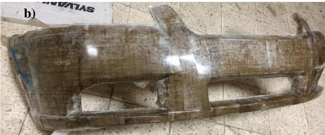
Figura 91. Vistas laterales del prototipo de guardachoque obtenido mediante VARTM. a) Izquierda, b) Derecha
