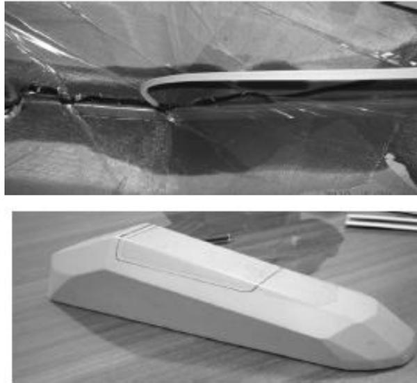
*Figura 26.* Infusión por Resina para la carrocería utilizada en la maratón ecológica de Malasya (Laraib et al., 2014).
