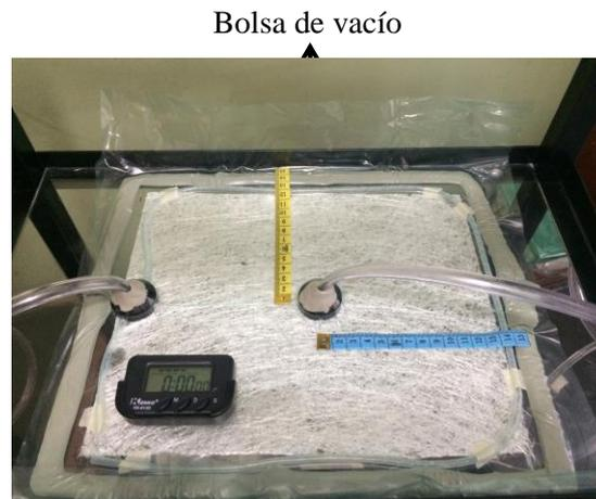
Figura 51. Disposición de materiales para la caracterización de permeabilidad según VARTM
