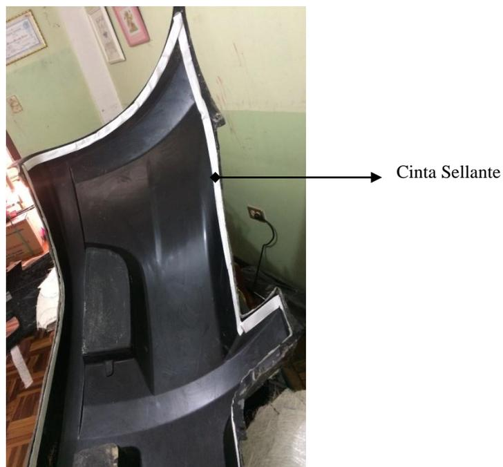
*Figura 66.* Colocación de la cinta sellante sobre el molde.
