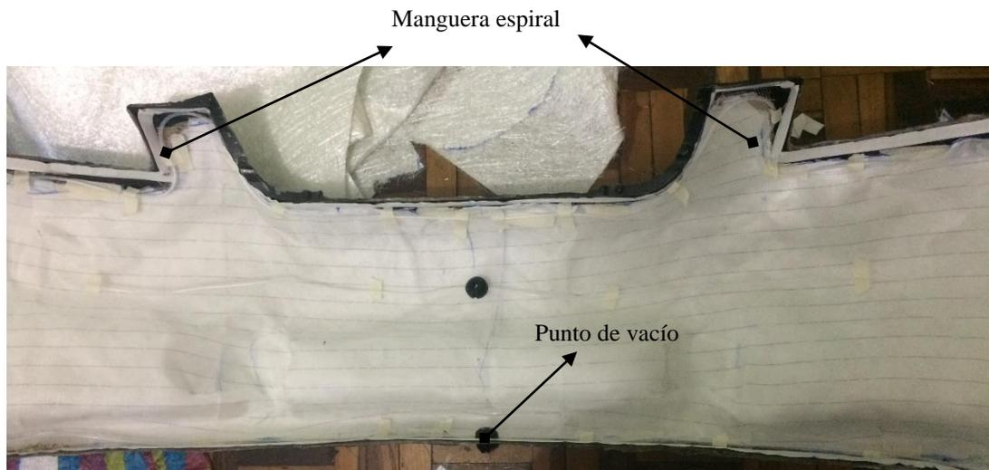
Figura 70. Ubicación de la manguera espiral y el punto de vacío utilizados para VARTM
