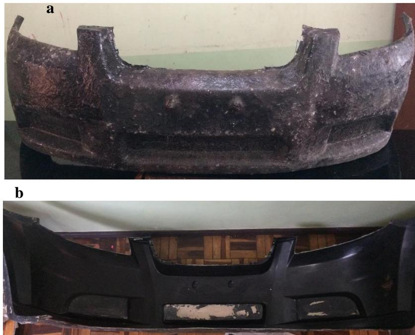
Figura 88. Molde del guardachoque del vehículo Chevrolet Aveo. a) Vista superficial externa, b) Vista superficial interna.
