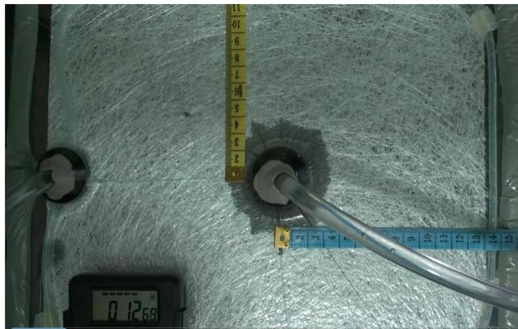
Figura 54. Inicio del experimento VARTM
