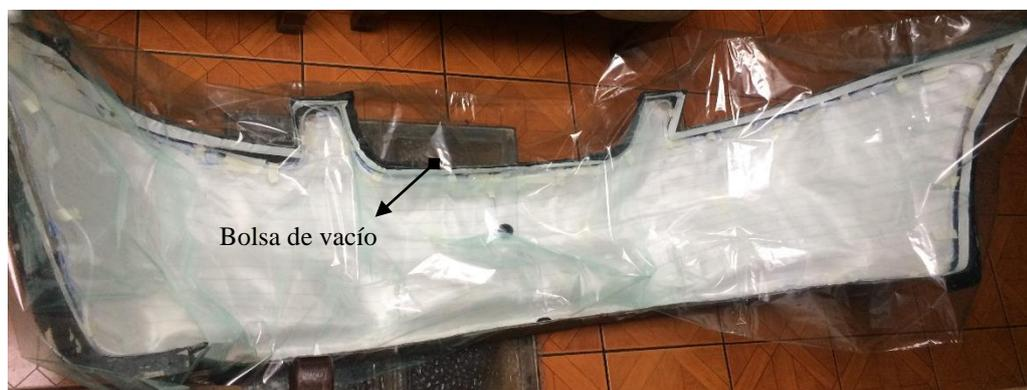
Figura 71. Bolsa de vacío utilizada para el proceso VARTM
