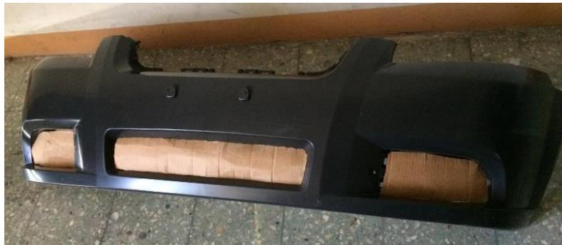
Figura 65. Disposición del guardachoque original para la fabricación del molde.
