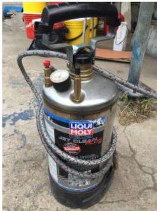
**Figura 23.** Tanque de presión de combustible. Fuente: Autor
