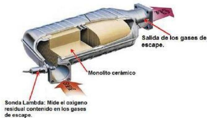
**Figura 6.** Convertidor catalítico. Fuente: (Hidalgo, 2010)
