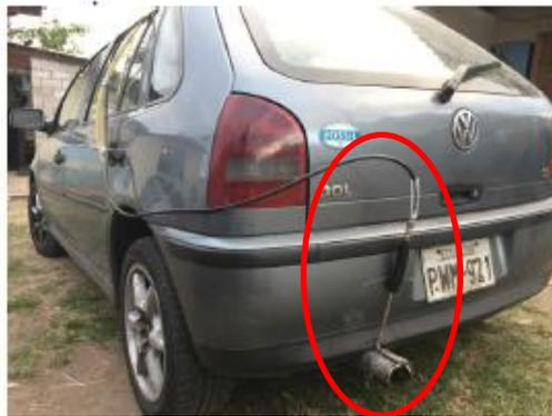
**Figura 21.** Sonda de gases. Fuente: Autor
