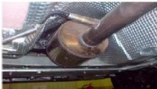
**Figura 7.** Ubicación del convertidor catalítico en el automóvil. Fuente: (Hidalgo, 2010).
