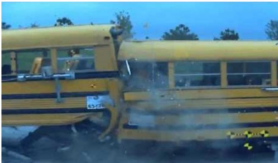
*Figura 4.* Ensayo de impacto por alcance de una carrocería de un bus escolar. Tomado Illescas. D, 2009.
