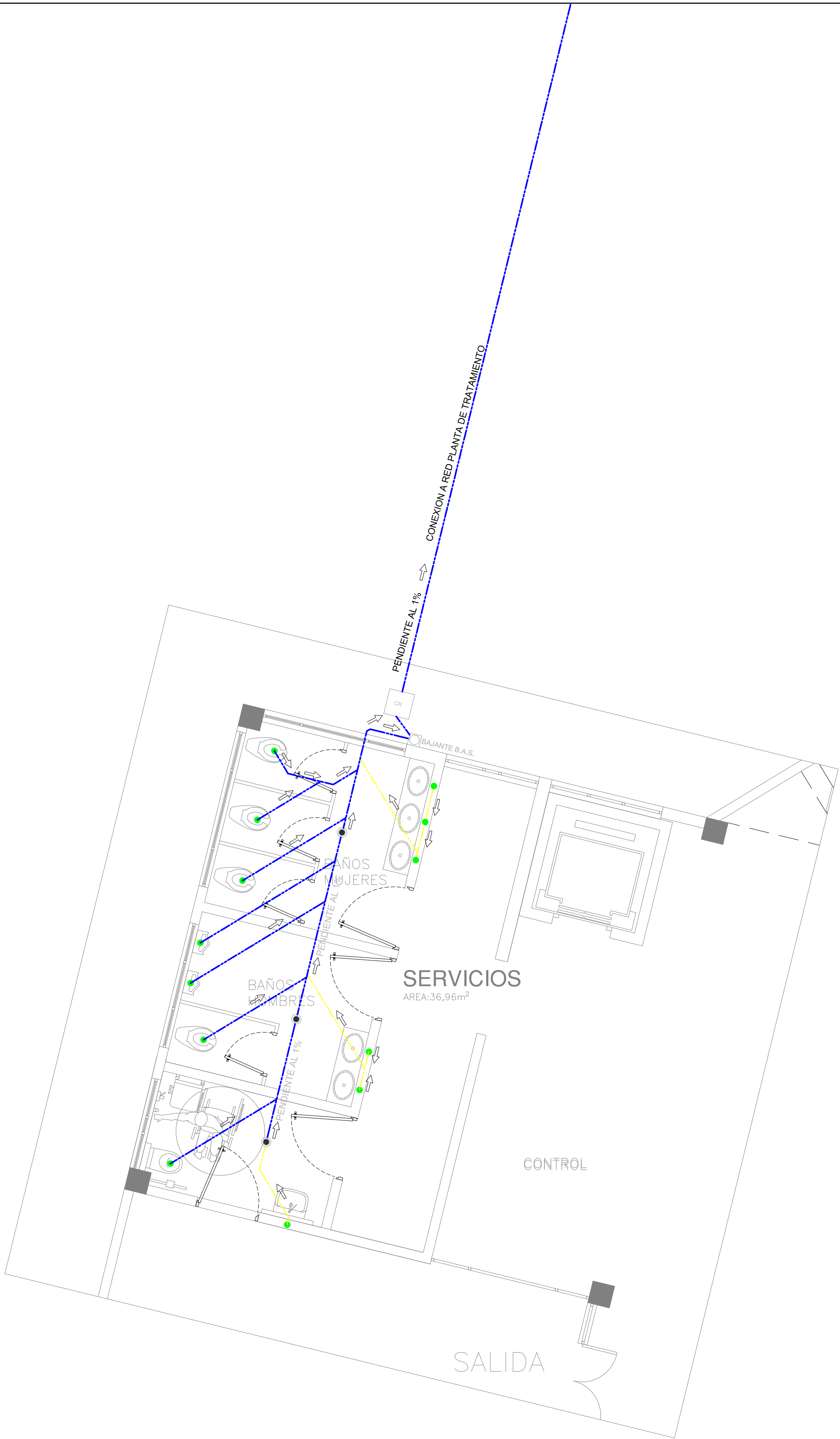
PLANTA TIPO INSTALACIONES SANITARIAS BLOQUE B
