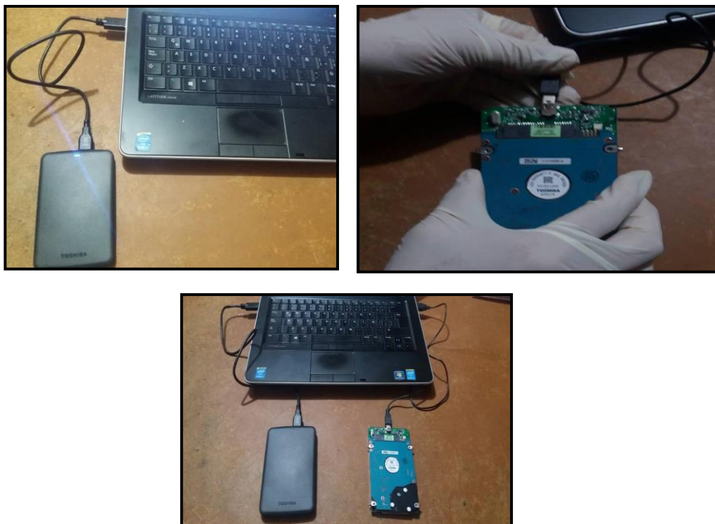
Figura No 22. Preparación para la creación de la imagen forense del disco duro
