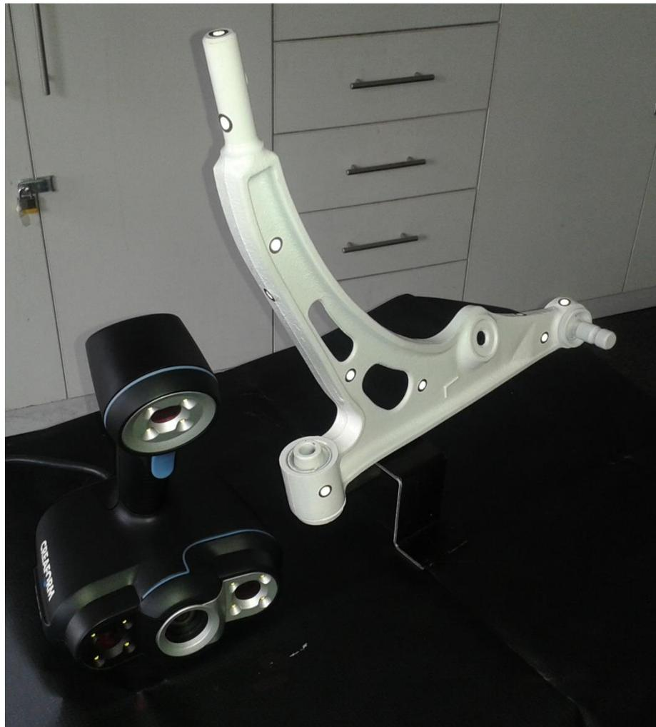
Figura 16. Equipo de escáner 3D y brazo de suspensión.
