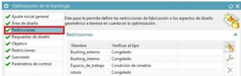
Figura 53. Restricciones geométricas.
