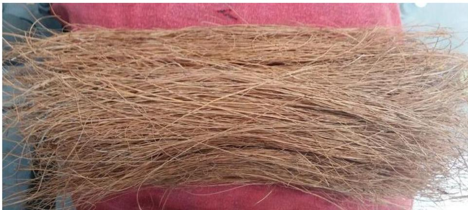
Figura 18. Fibra continua longitudinal
