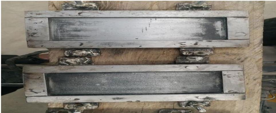
Figura 17. Moldes para construcción de probetas
