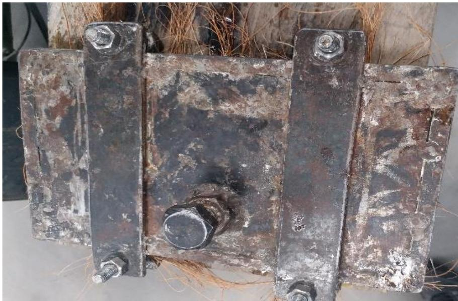
Figura 23. Compresión del material por medio de placas
