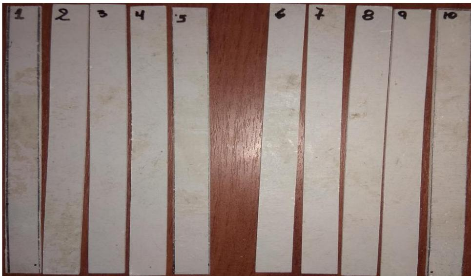
Figura 25. Obtención de probetas para ensayos a flexión
