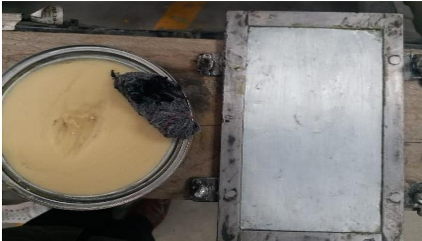
Figura 20. Encerado de los moldes de fabricación de probetas
