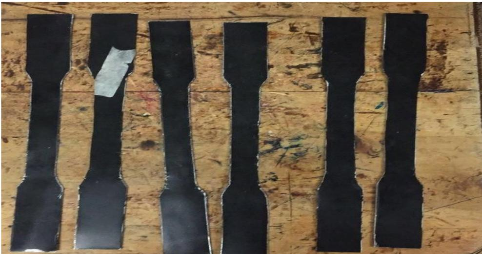
Figura 27. Probetas del material homogéneo basados en la norma ASTM E8
