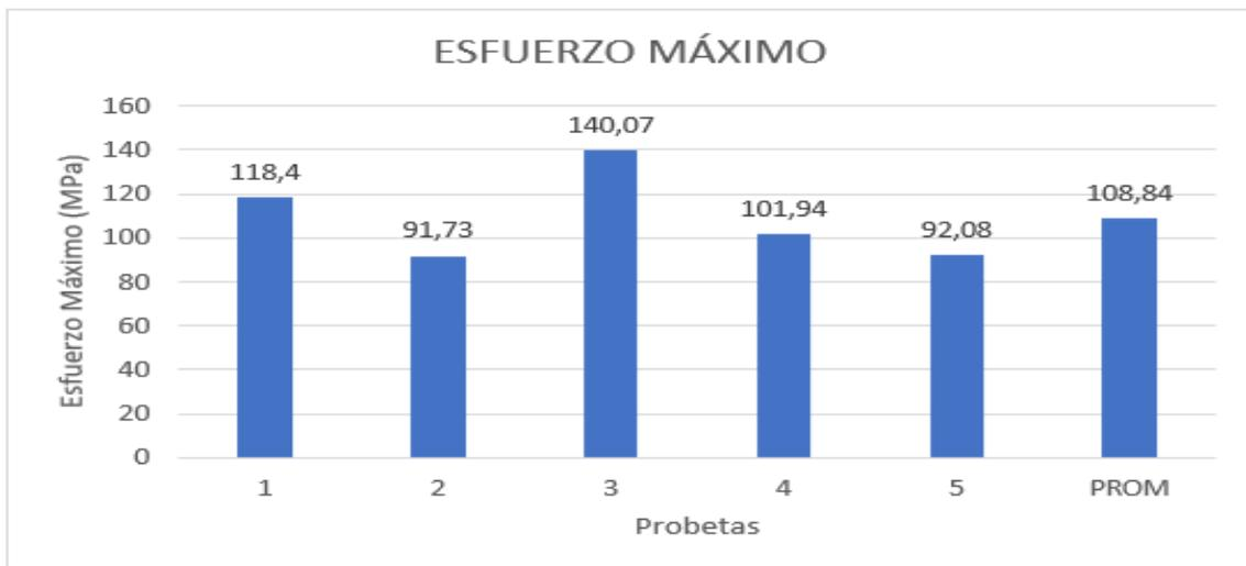
Figura 39. Valores de esfuerzo máximo del ensayo a flexión segunda configuración
