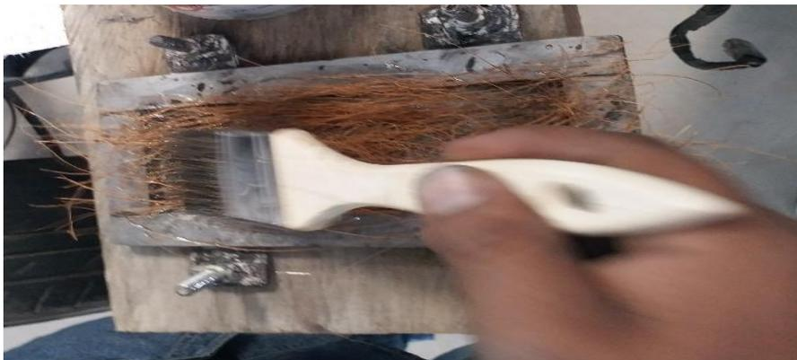
Figura 21. Mezcla de resina y fibra de coco
