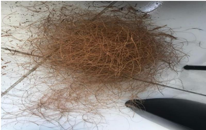
Figura 16. Extracción manual de la fibra de coco
