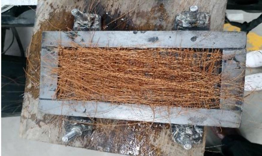
Figura 22. Llenado de los moldes con fibra considerando su orientación
