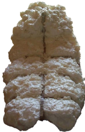
Figura 71. Moldeo de la butaca con espuma Poliuretano
