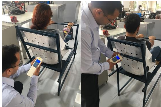
Figura 66. Medidor de fuerza digital de 200N
