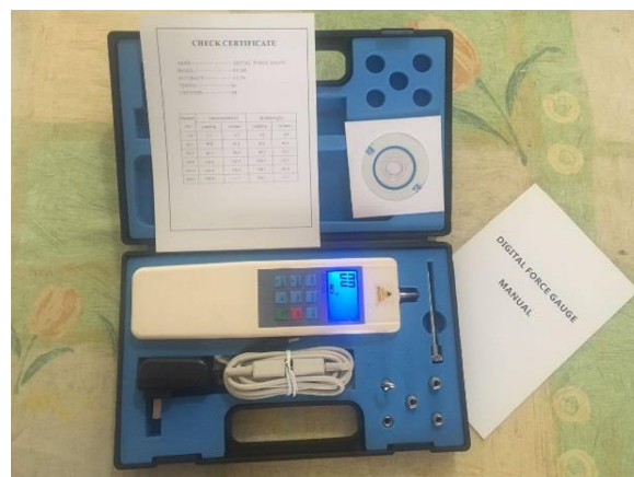
Figura 34. Medidor de fuerza digital de 200N
