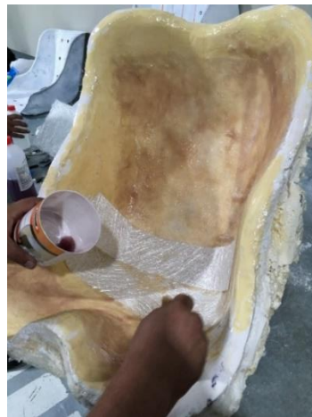
Figura 86. Fabricación de la butaca reforzada con fibra de vidrio
