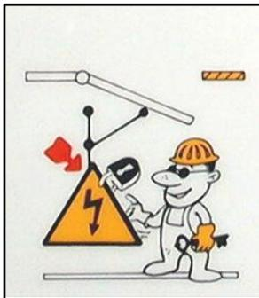
Bloquear y etiquetar los aparatos o herramientas que sean utilizadas para el bloqueo de la energía, de esta manera se evitará accidentes de energización del área de trabajo
