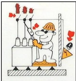
**Verificación de la ausencia de tensión.** Antes de realizar esta operación, la instalación se considerará en tensión. El operario utilizará un multímetro para comprobar la tensión, guantes de protección y aislamiento del suelo (botas o alfombra aislante) adecuados al nivel de tensión de la instalación
