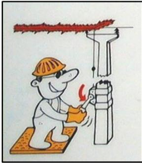
Abrir, con corte visible, todas las fuentes de tensión, mediante interruptores y seccionadores que aseguren la imposibilidad de su cierre intempestivo (Separar todas las fuentes de energía que puedan alimentar el área de trabajo)
