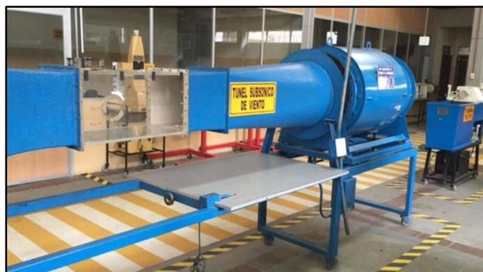
*Figura 1.* Túnel de viento a escala (Laboratorio de termo fluidos de la facultad de ingeniería en mecánica y ciencias de la producción (FIMCP))
