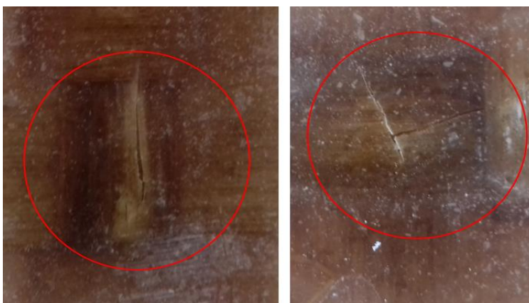
Figura 63. Grietas producidas por el choque térmico. Fuente: Autor
