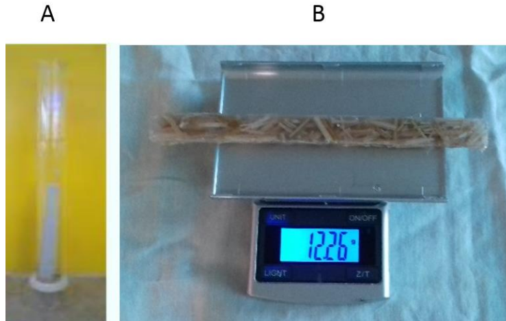
Figura 36. Determinación de la densidad y peso de las probetas.
