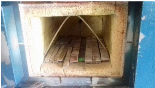
Figura 62. Distribución de las probetas en el horno. Fuente: Autor
