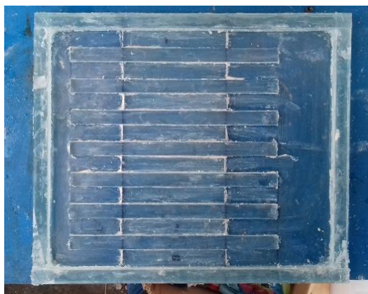
Figura 30. Molde elaborado en vidrio Fuente: Autor
