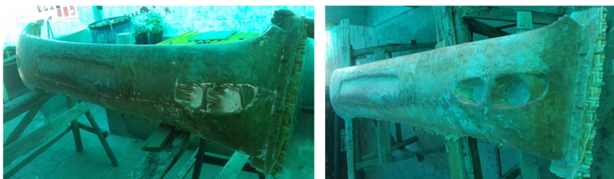
Figura 81. Vista isométrica de prototipo de parachoques para bus. Fuente: Autor
