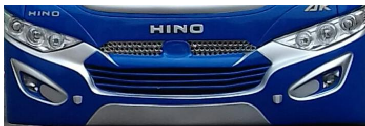
Figura 6. Parachoques delantero autobús, manufacturado en base de resina de poliéster y refuerzo de fibra de vidrio. Fuente: Autor
