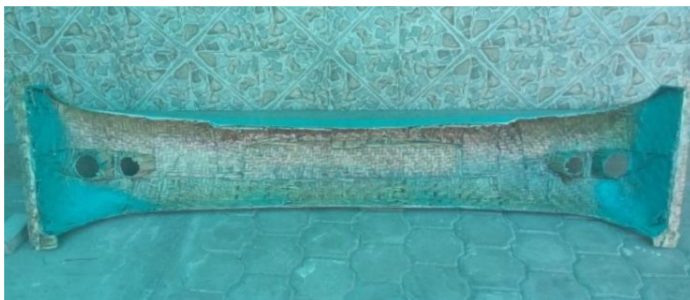
Figura 82. Vista posterior de prototipo de parachoques para bus. Fuente: Autor
