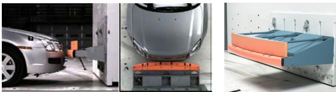
Figura 45. Barrera de parachoques de acero con anti retorno Fuente: (RCAR, 2010)
