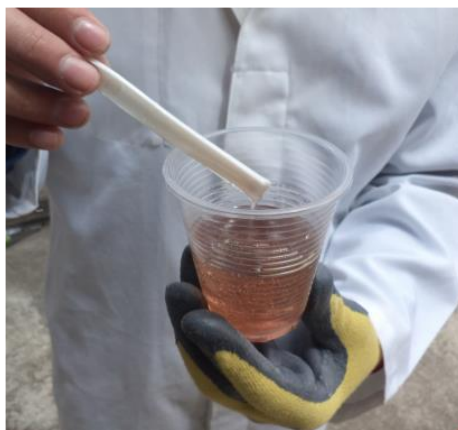
Figura 28. Matriz conformada por resina de Poliéster 33000, Cobalto y MEC. Fuente Autor
