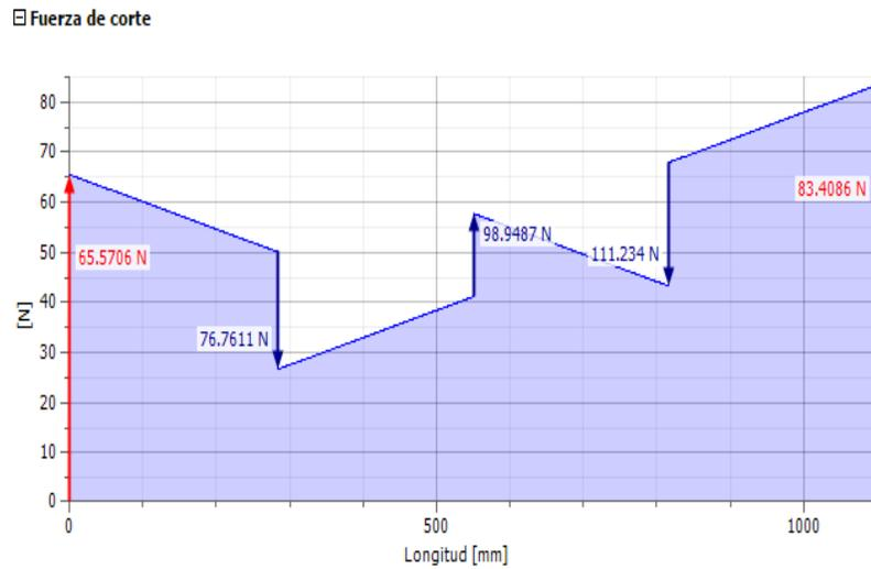
Figura 24. Diagrama de cortante para el eje principal
