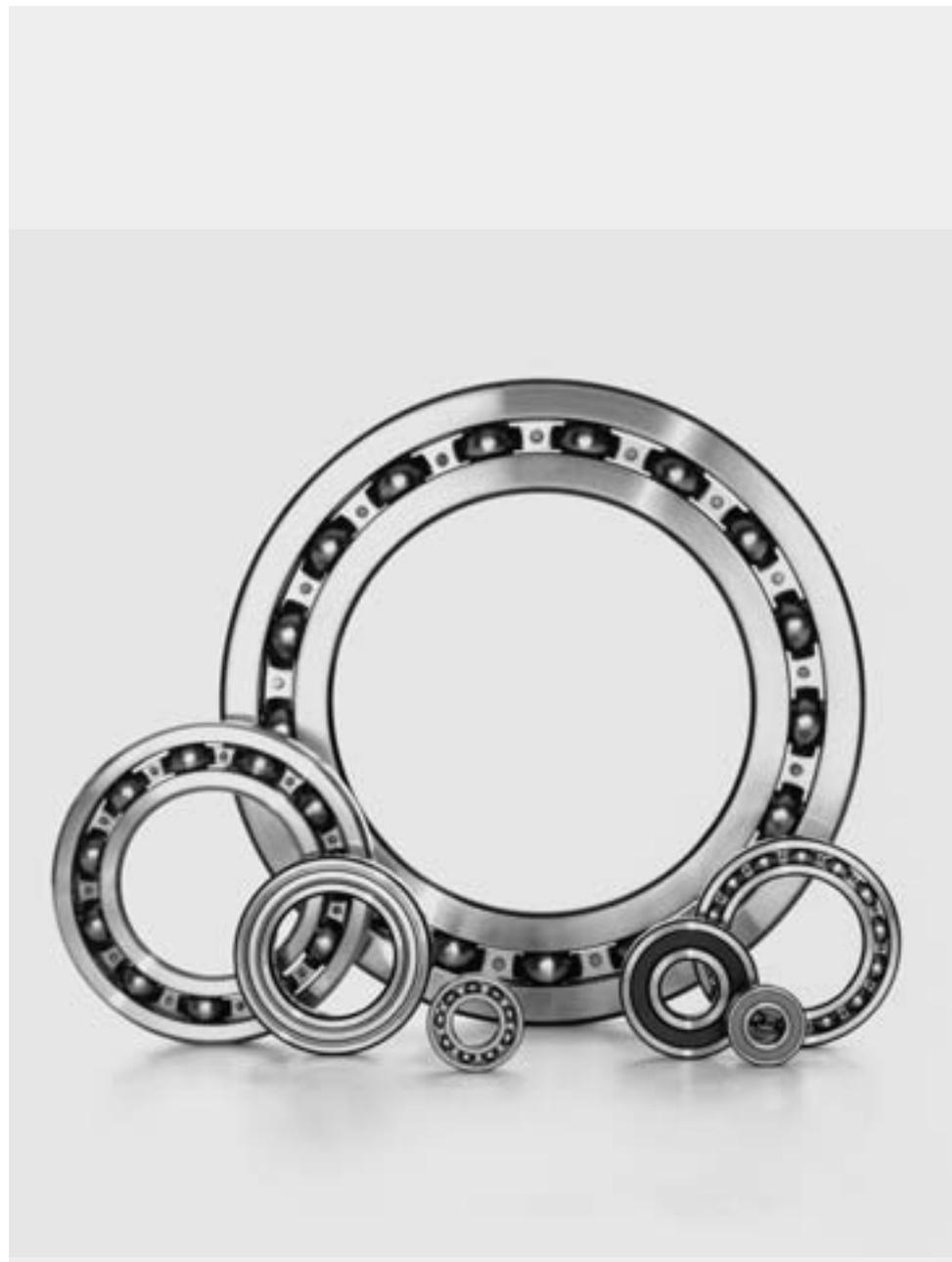
Los rodamientos rígidos con una hilera de bolas soportan cargas radiales y axiales, además son apropiados para revoluciones elevadas. Estos rodamientos no son despiezables y su adaptabilidad angular es relativamente pequeña. Los rodamientos rígidos de bolas obturados están exentos de mantenimiento y posibilitan construcciones sencillas. Por su gran variedad de aplicaciones y debido a su precio económico, los rodamientos rígidos de bolas son los más usados entre todos los tipos de rodamientos.
