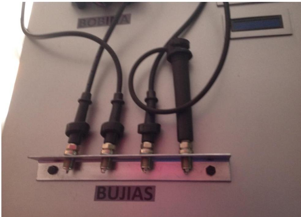
*Figura 36:* Conexión de bujías del sistema DIS
