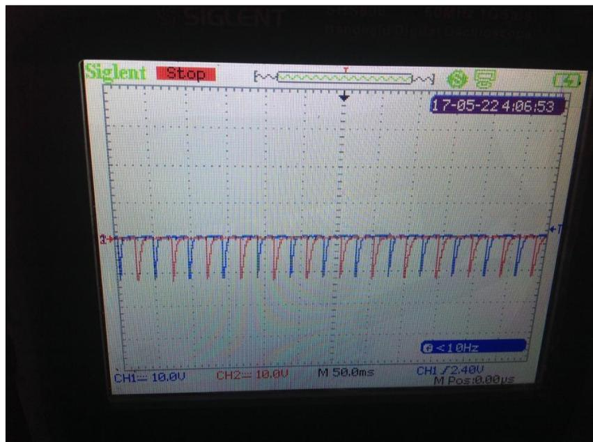
Figura 79: Señales de entrada desde el microcontrolador hacia la bobina DIS (desconectada)
