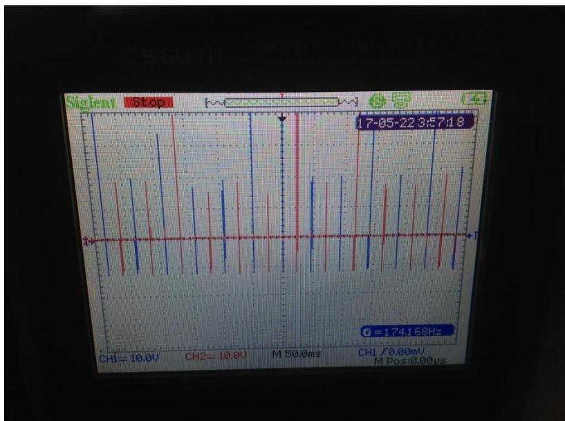
Figura 78: Señal de entrada desde el microcomputador hacia la bobina de encendido DIS
