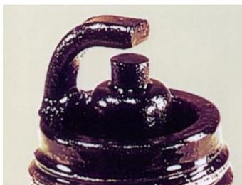
*Figura 14:* Bujía con depósitos de aceite. (Agueda, 2009)
