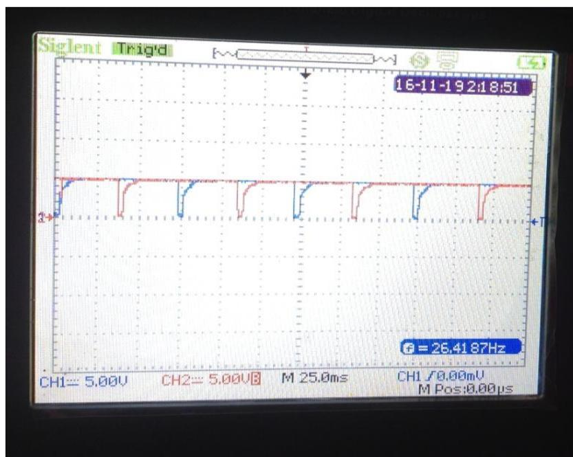
Figura 76: Señal del sensor CKP y CMP del sistema COP a 1584 rpm
