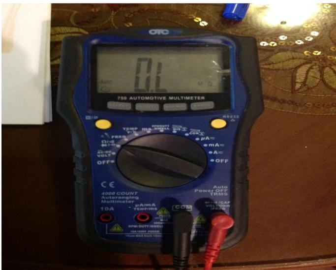
3.-Ubicar las puntas de prueba en los bornes del tablero correspondiente a cada bobina, sin importar el color de las puntas del multímetro
