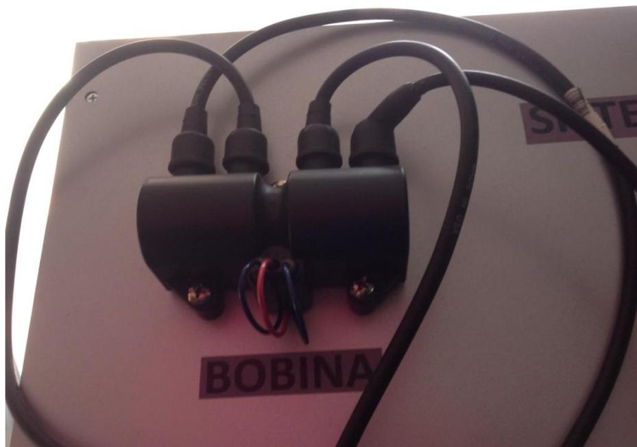
*Figura 35: Bobina de encendido DIS*
