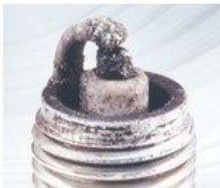
*Figura 13:* Fusión de los electrodos. (Agueda, 2009)
