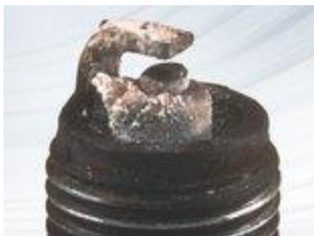
*Figura 12:* Depósitos en la bujía. (Agueda, 2009)
