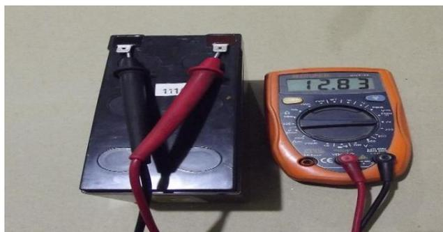
Figura 58: Multímetro con indicación de voltaje
