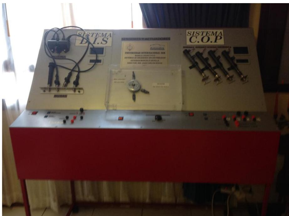
Figura 68: Tablero de pruebas del sistema de encendido sin distribuidor
