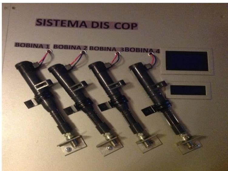
Figura 47: Bobinas de encendido electrónico COP
