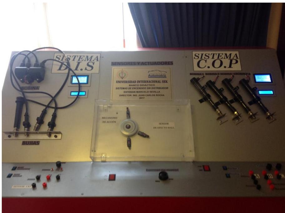
Figura 69: Tablero de pruebas encendido
