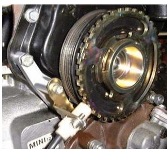
*Figura 17:* Ubicación del sensor CKP. (Electrónica del auto, 2012)
