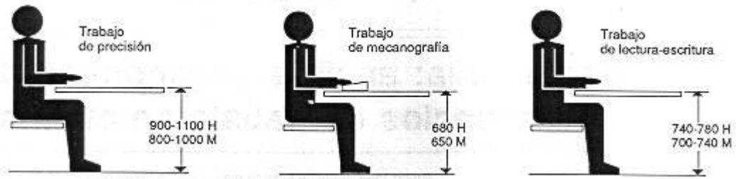
**Figura 1: distancias para distintos tipos de trabajo (cotas en mm)**
