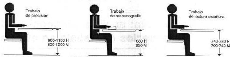
Figura 18. Altura del plano de trabajo para puestos de trabajo sentado (cotas en mm)
