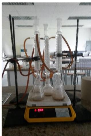
**Ilustración 14.** Proceso de digestión con reflujo
