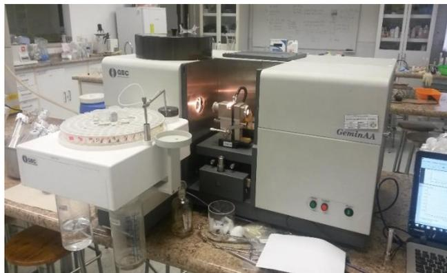
**Ilustración 17.** Espectrofotómetro de absorción atómica con horno de grafito
