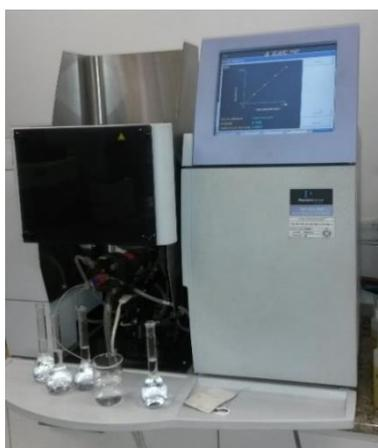
**Ilustración 18.** Espectrofotómetro de absorción atómica con llama
