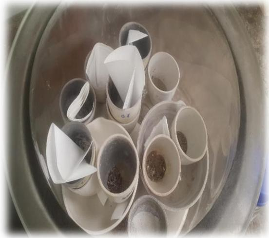
Figura 25: Almacenamiento del óxido calcinado en el desecador tras la calcinación
