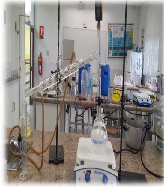
Figura 20 y 21: Determinación de los Índices de Saponificación y Peróxidos
