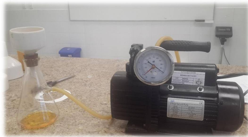
Figura 29: Proceso de filtración al vacío.
