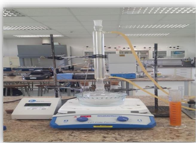
Figura 7: Reactor discontinuo para transesterificación.
