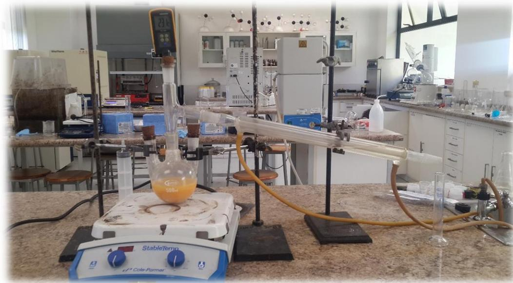
Figura 28: Recuperación del Metanol por destilación.
