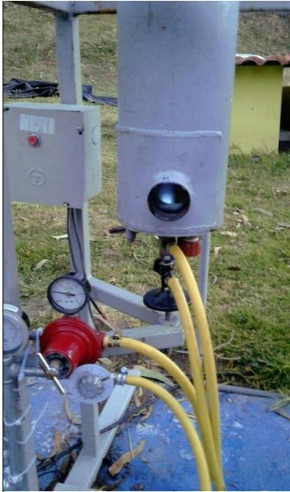
**Figura 5.** Sistema de generación y enfriamiento de CO<sub>2</sub>.
