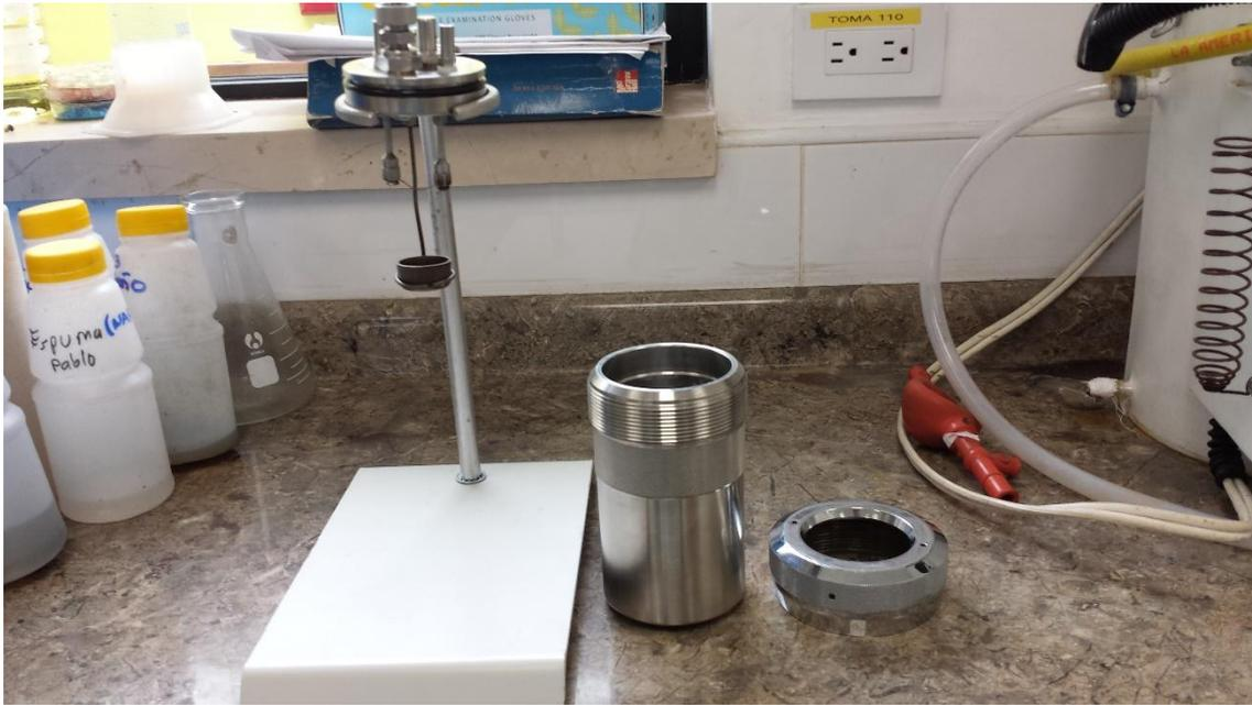
Imagen No 7. Montaje de pellet en bomba calorimétrica
