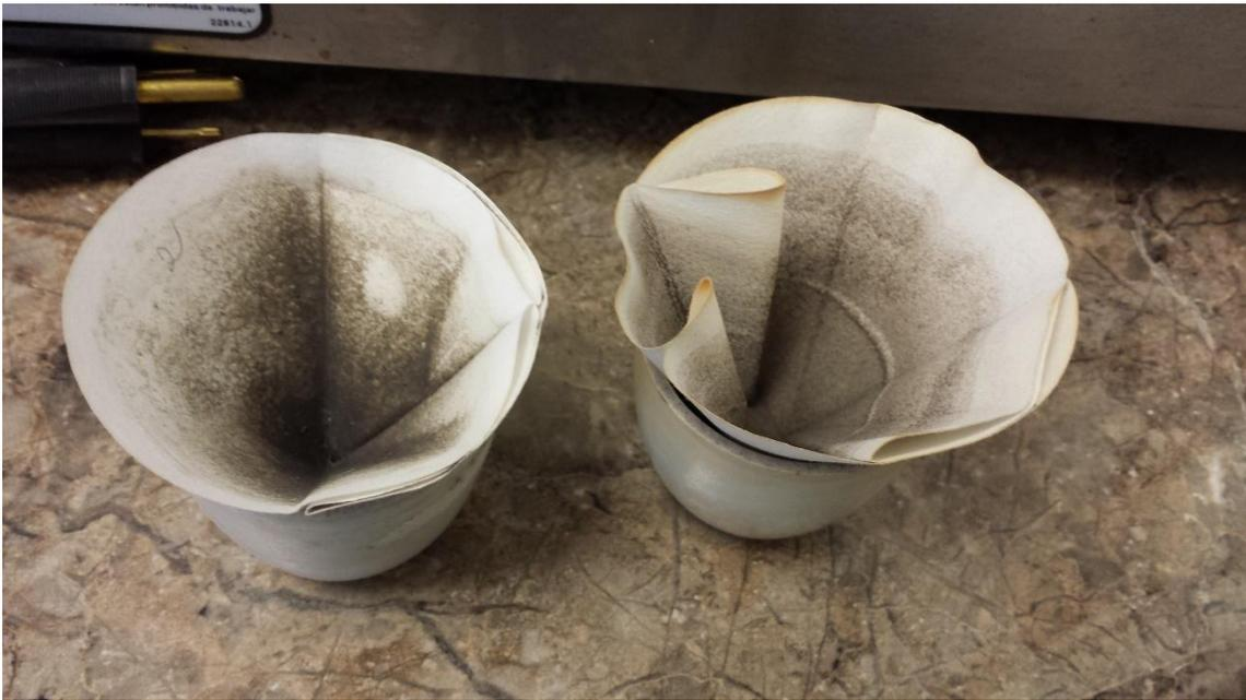
Imagen No 12. Determinación de porcentaje de azufre por diferencia de peso
