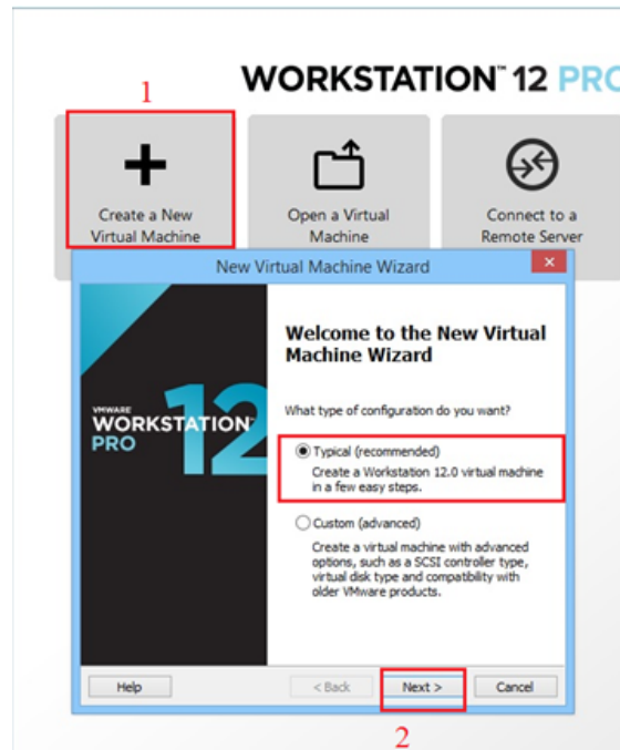
Figura #25. Asistente de instalación de nueva máquina virtual. Elaborado por: Danilo Ninabanda.
