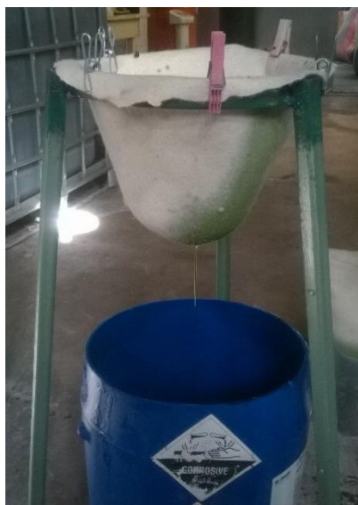
Anexo C3. Equipo de filtración, utilizado en la filtración del colorante
