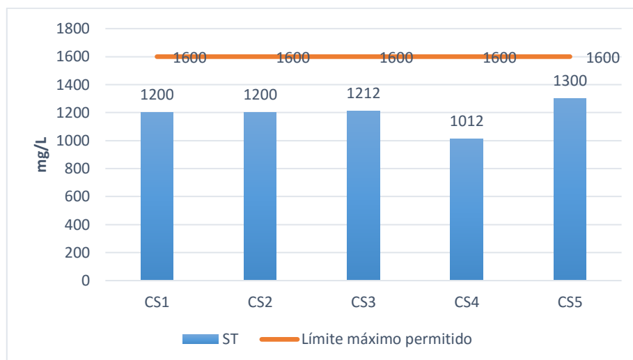
Figura 24. ST en las aguas residuales de las tinturas con colorantes sintéticos, comparados con la norma ambiental.
