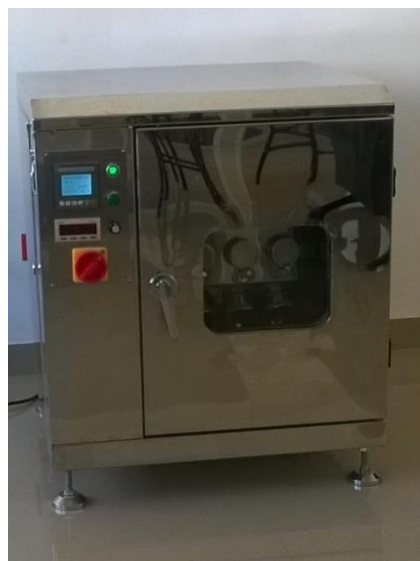
Anexo C4. Máquina para tintura, tipo de laboratorio, modelo RHS-24
