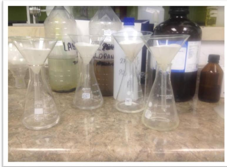
*Figura 9: Fotografía correspondiente a filtración de agua de lluvia para determinación de sólidos suspendidos. Tomada por Carolina Marcial, 2016*
