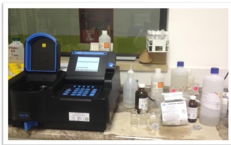
Figura 14: Fotografía correspondiente determinación de sulfatos por método 8051. Tomada por: Carolina Marcial, 2016
