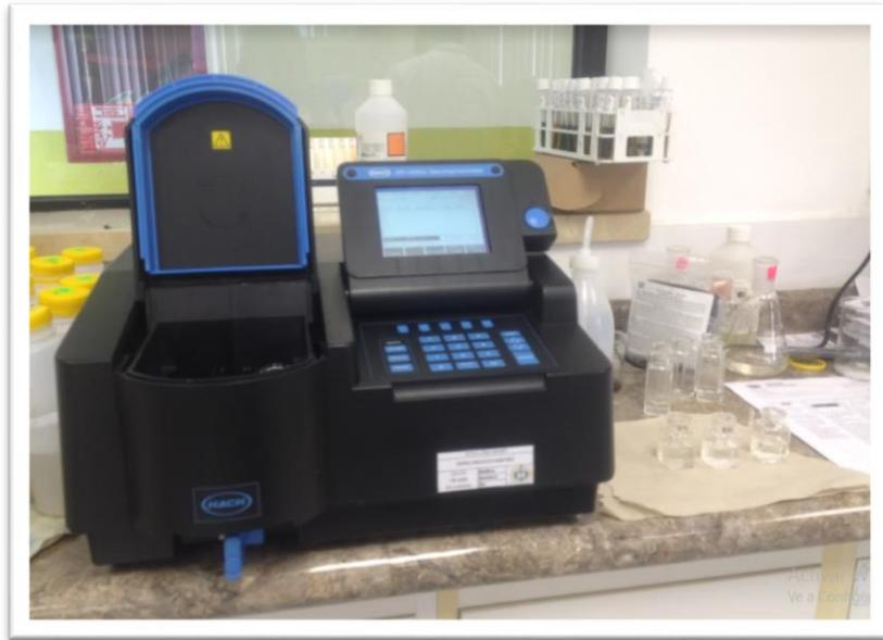
Figura 15: Fotografía correspondiente a equipo HACH muestreo de nitritos. Tomada por Carolina Marcial, 2016
