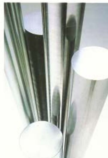
La fusión del acero es entre 1.400 y 1.500°C; en la imagen piezas cilíndricas de acero.
