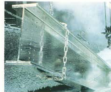
Inmersión en un baño de zinc fundido a 450°C, en el proceso de galvanización.
