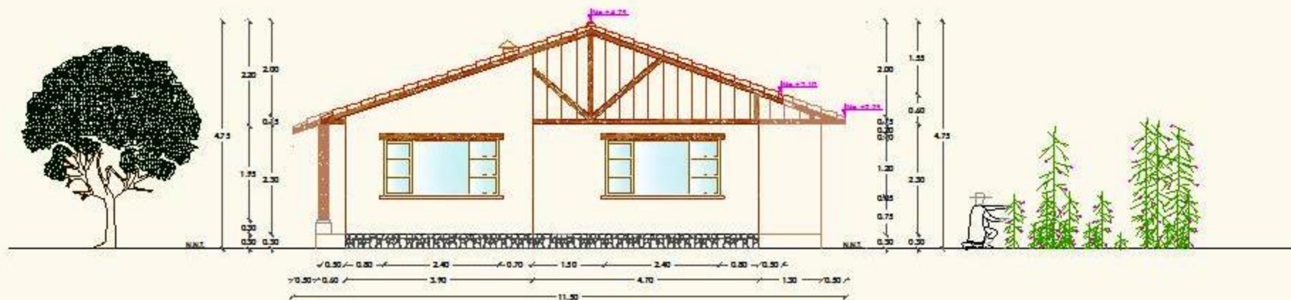
FACHADA LATERAL DERECHA VIVIENDA TIPO A
