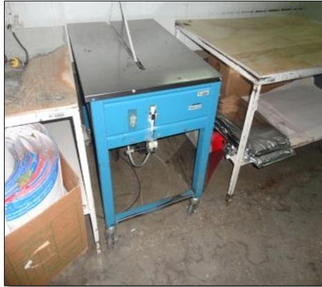
Figura 4.9. Máquina para zunchar
