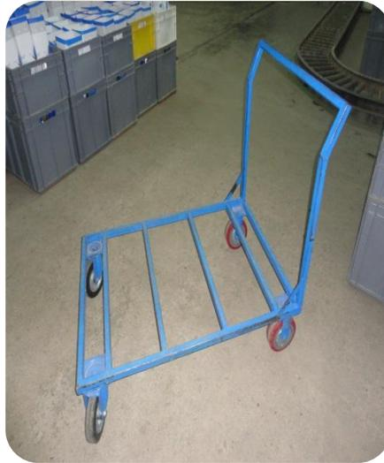
Fig. 4.5 Carro abierto se utilizara para transportar cajas al área de embarque
