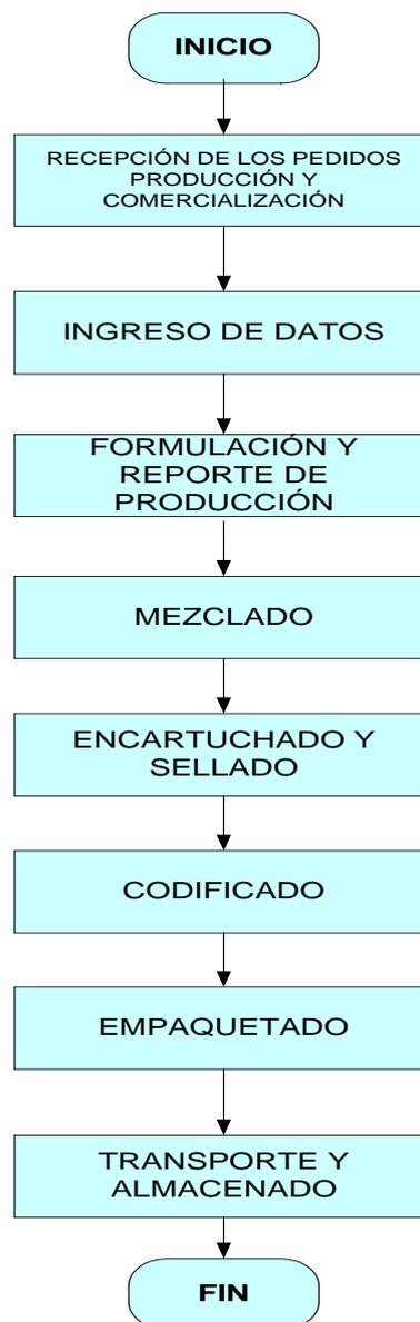
Ilustración 2. Diagrama de flujo de la línea de producción de dinamita
