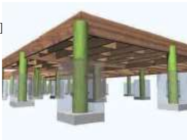
CIMENTACION MEDIANTE PILAS
