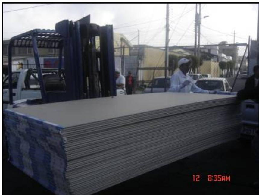
Este material consiste en un mortero de yeso integrado de componentes aglutinantes propios de cada fabricante, solidificados y compactados dentro de 2 capas de papel reciclado tipo kraft que se venden en el mercado en planchas de diferentes tamaños, espesores, y aplicaciones de uso.
