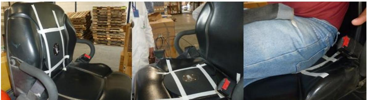
**Fig.4.7.** Puntos donde se realizaron las medidas de Vibraciones cuerpo entero. Asiento y espaldar. Asientos en perfecto estado.
