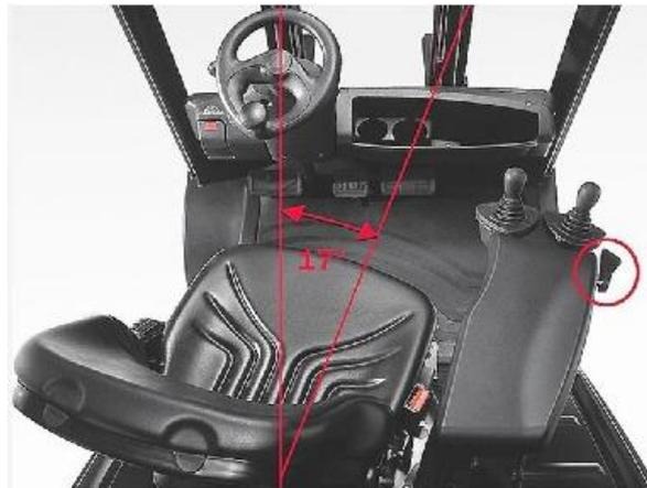
**Fig. 4.19.** Asiento ergonómico, giratorio, antivibratorio en montacargas
