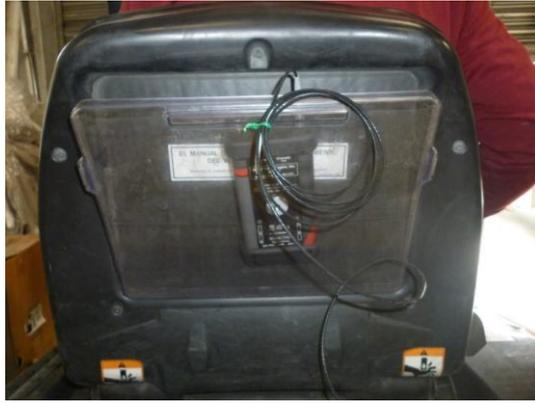
**Fig. 3-11,** Ubicación del acelerómetro mientras se realiza la medición de VCE.
