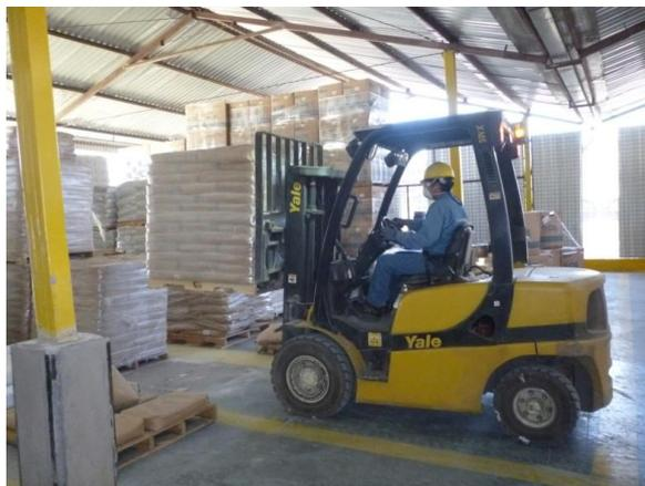
**Fig. 3-7,** Montacargas Yale, Modelo GP050-070VX
