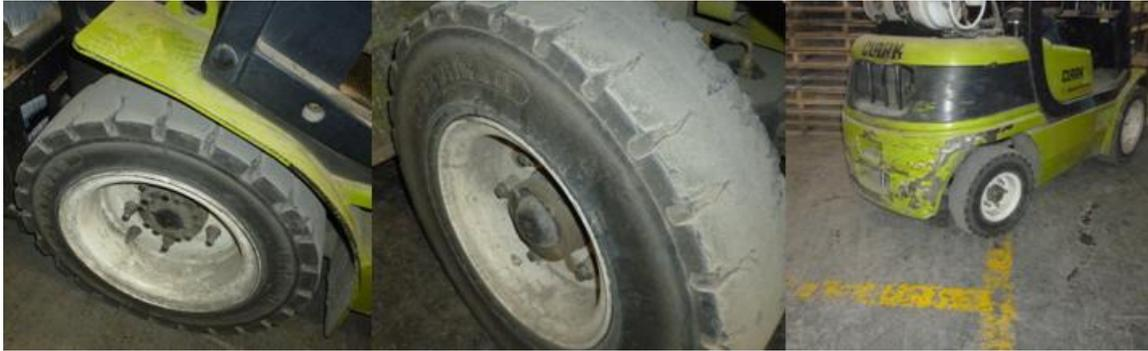
**Fig. 4.14.** El montacargas CLARK con neumáticos bastante desgastados y un estado de mantenimiento no muy adecuado.
