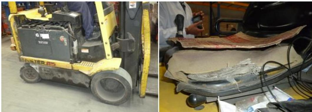
**Fig. 4.2.** El montacargas Hyster con deterioro en su estructura y asiento.
