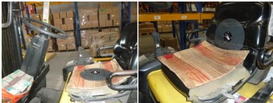
**Fig.4.3.** Puntos donde se realizaron las medidas de Vibraciones cuerpo entero. Asiento y espaldar.
