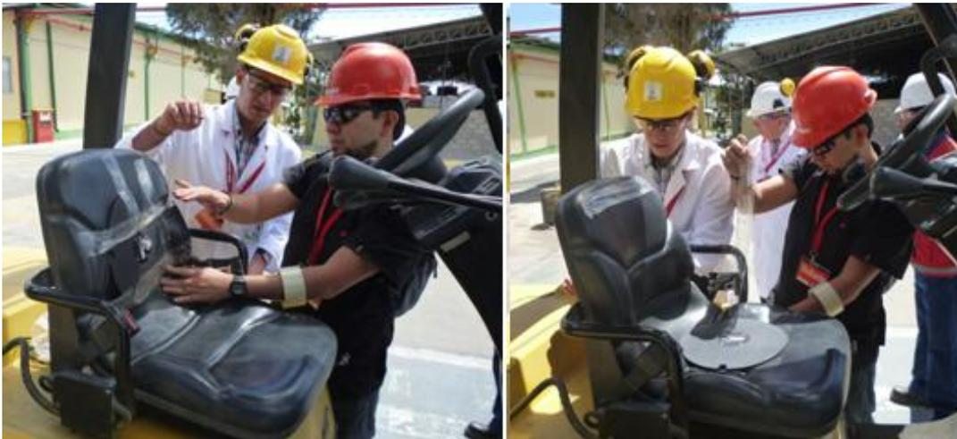
**Fig.4.10.** Puntos donde se realizaron las medidas de Vibraciones cuerpo entero. Asiento y espaldar. Asientos en perfecto estado.
