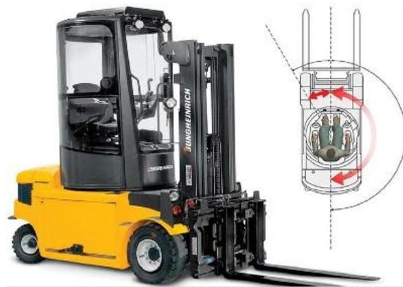
**Fig. 4.18.** Cabina de montacargas con diseño ergonómico
