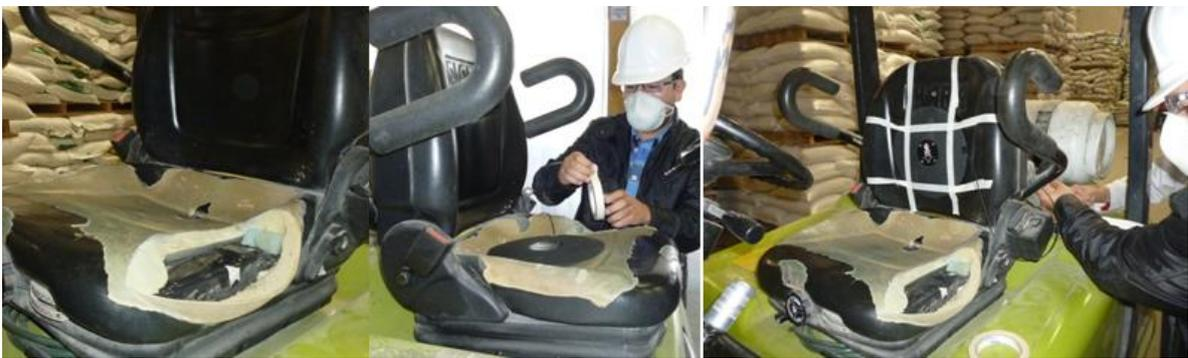
**Fig.4.15.** Puntos donde se realizaron las medidas de Vibraciones cuerpo entero en montacargas CLARK. Asiento y espaldar. Obsérvese el asiento destruido.
