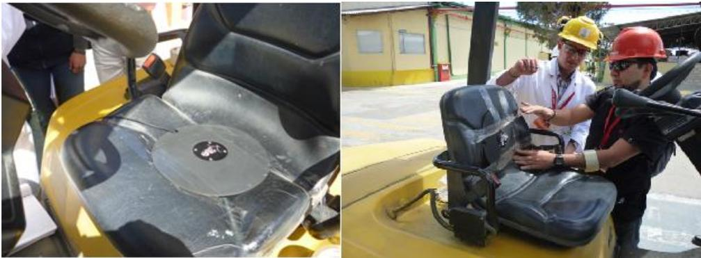
**Fig. 3-12,** Instalación del transductor en asiento y espaldar del montacargas.
