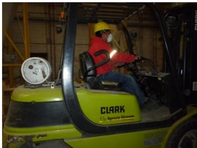
**Fig 4.13.** Montacargas CLARK a gas operando en el movimiento de pallets con materia prima.
