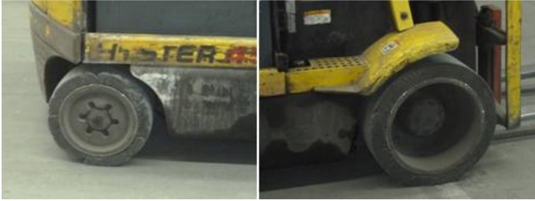
**Fig. 4.1.** Mal estado de las llantas tipo sólidas en montacargas Hyster.
