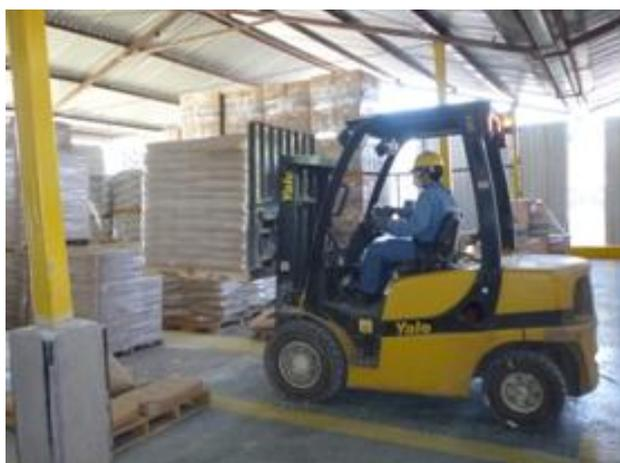
**Fig. 4.8.** Montacargas YALE operando en el movimiento de pallets con materia prima.
