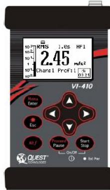
**Fig. 3-1,** Acelerómetro QUEST, VI-400Pro
