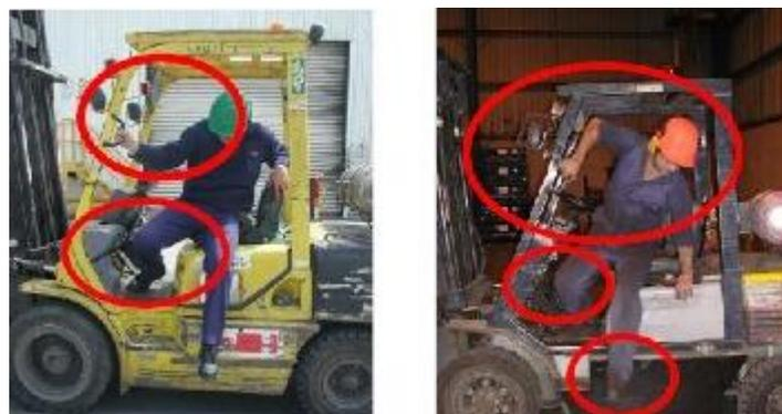
**Fig. 4.21.** Técnica adecuada para descender del montacargas
