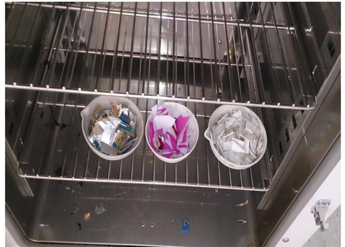
Las muestras una vez pesadas deben colocadas en una estufa a 105°C durante 24 horas , una vez pasada las 24 horas se debe pesar nuevamente los crisoles y disponer a la mufla durante 4 horas a 650°C a las categorías correspondientes a papel cartón, textil y materia orgánica
