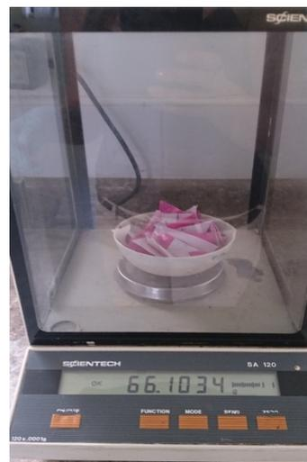
Una vez que se dispone el material en lo crisoles se procede a aforar material, cabe aclarar que previamente se debe tomar el peso del crisol vacío
