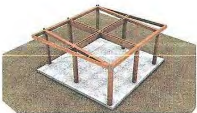
Construcción contrapiso y estructura primera planta
