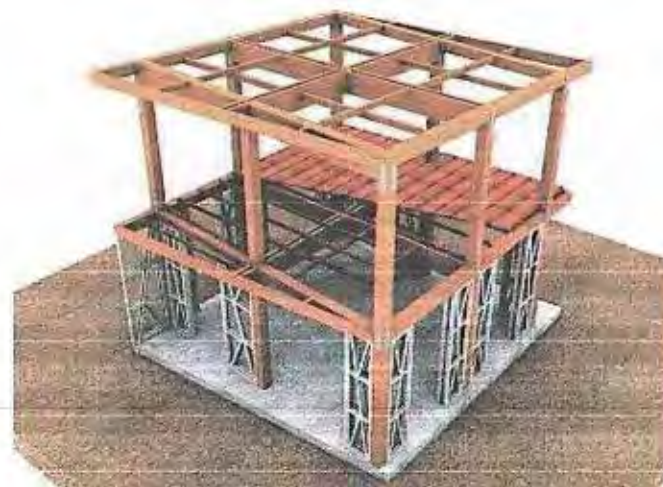
Armado de estructura segundo piso
